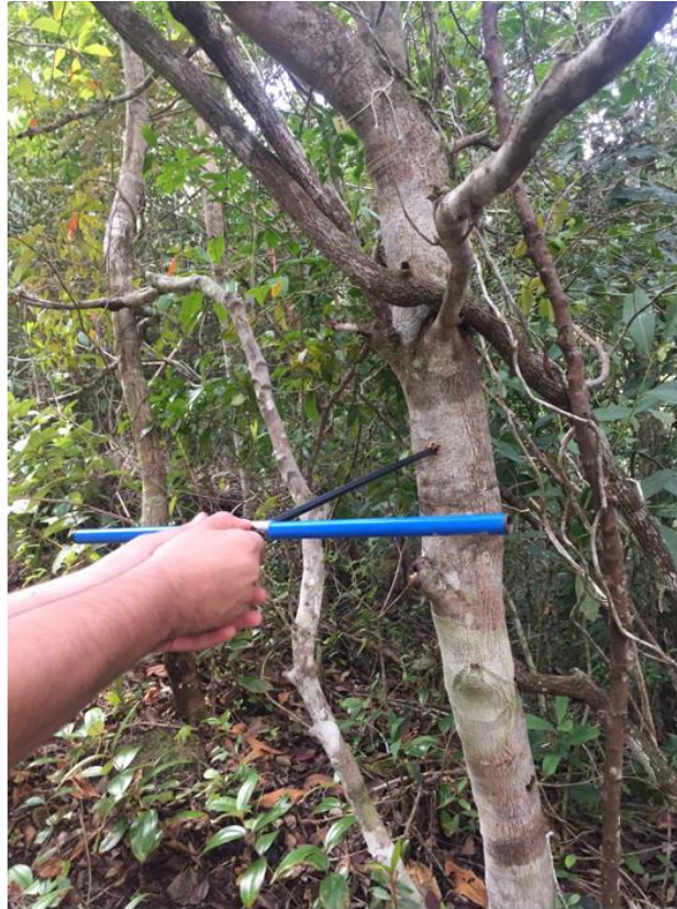
Figura 7: Extração do corpo de prova através da sonda de Pressler. Fonte: Acervo pessoal.
