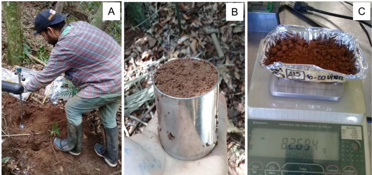
Figura 7. Ferramentas utilizadas na coleta de amostras do solo de fragmentos de FES no município de São Francisco de Itabapoana, RJ. (A) Trado de amostra indeformada sendo utilizado para coleta até 100 cm. (B) Anel volumétrico (100 cm 3 ) desacoplado e preenchido pela amostra (C) Pesagem do solo seco para obtenção da densidade aparente do solo.
