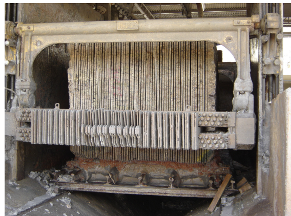
Figura 2.2 – (a) Blocos de Rocha em Estado Bruto; (b) Processo de Serragem no Tear.
