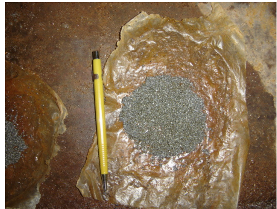
Figura 2.3 – (a) Lama Abrasiva na Serragem dos Blocos; (b) Granalha.
