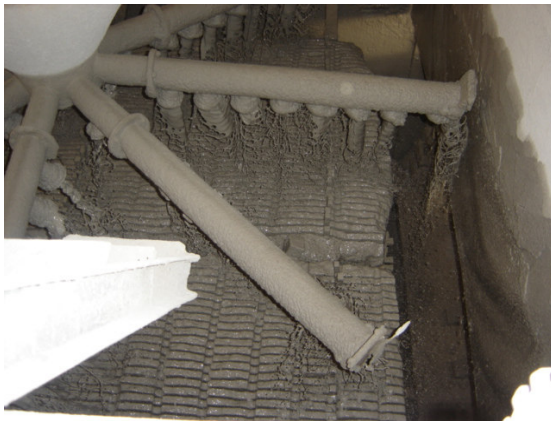
Figura 2.3 – (a) Lama Abrasiva na Serragem dos Blocos; (b) Granalha.
