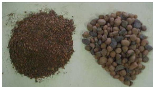
Figura 4.2: Agregados leves utilizados na pesquisa: miúdo (material da esquerda) e graúdo (material da direita).
