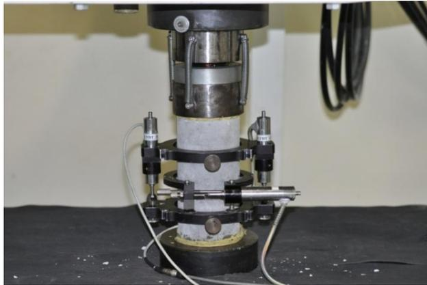
Figura 4.8: Detalhe dos transdutores de deslocamento horizontal.
