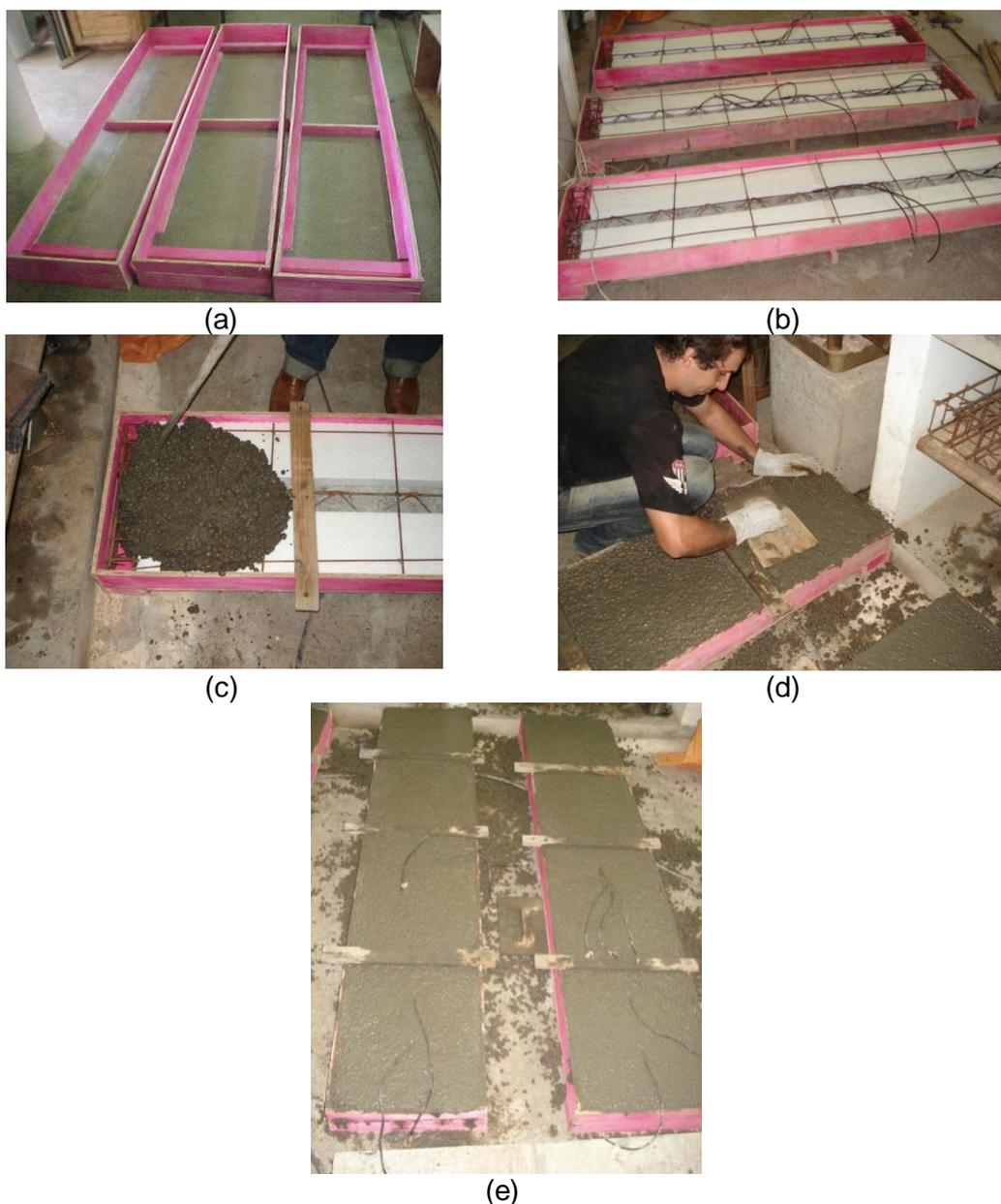
Figura 4.13: Etapas da moldagem das lajes – (a) formas de madeira, (b) formas de madeira com as vigotas e material de enchimento, (c) lançamento do concreto e vibração, (d) acabamento, (e) lajes concretadas.
