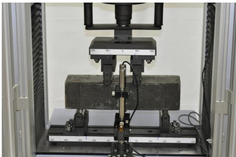
Figura 4.9: Prensa Hidráulica Shimadzu de 30 kN do Laboratório de Estruturas e Materiais da COPPE/UFRJ.
