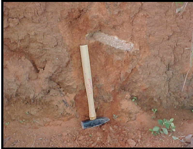
Foto 17: Detalhe de um corte com Cambissolo. A presença de fragmentos de rocha é característica deste tipo de solo (Fonte: Corrêa, 2003).
