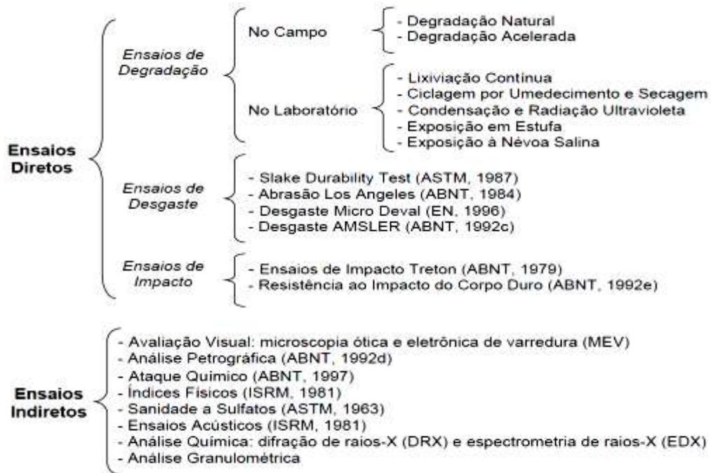
Figura 3.1: Classificação dos ensaios para avaliação da degradação (Salles 2006).
