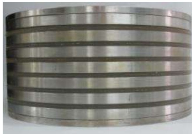
Figura 4.19: Câmara de compressão montada composta de anéis de aço inoxidável justapostos e intercalados a anéis de silicone.
