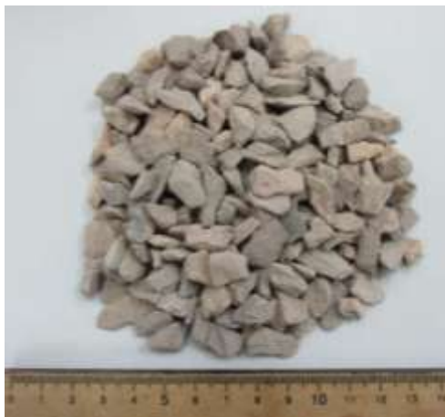
Figura 4.23: Material granular do enrocamento de arenito da Barragem de Manso, utilizado nos corpos de prova do programa experimental.
