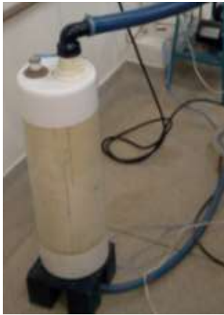
Figura 4.16: Reservatório inferior do sistema de esvaziamento
