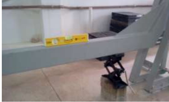
Figura 5.4: Detalhe do apoio do braço alavanca durante a aplicação de um incremento de carga.
