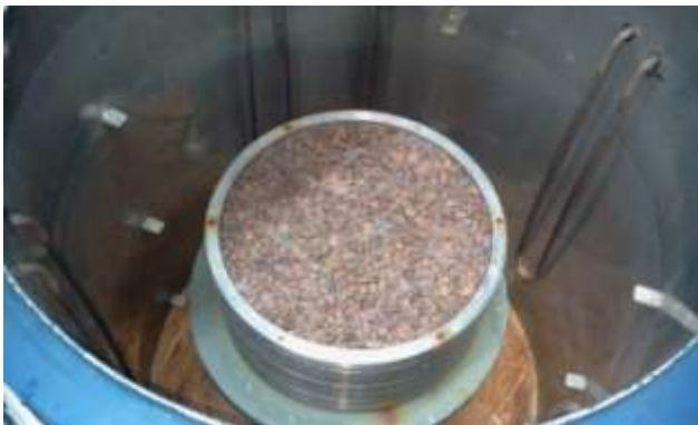
Figura 4.11: Câmara de compressão dentro da câmara de degradação com corpo de prova já moldado.
