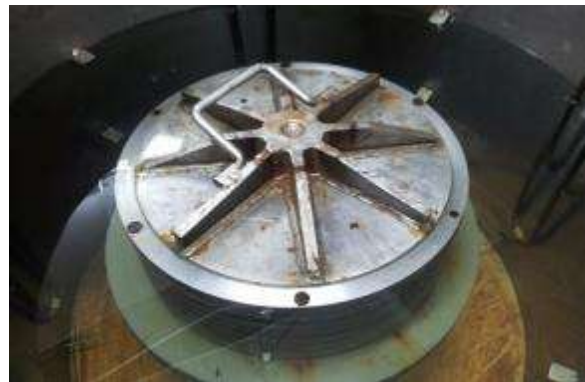
Figura 4.12: Câmara de compressão inserida no interior da câmara de degradação inundada.
