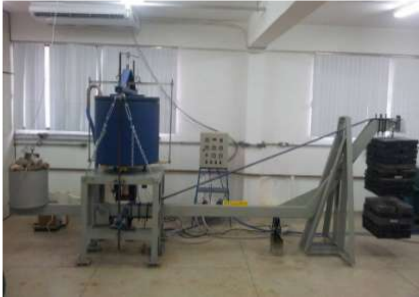
Figura 4.9: Equipamento de saturação e secagem automático acoplado ao equipamento de compressão confinada de grandes dimensões.
