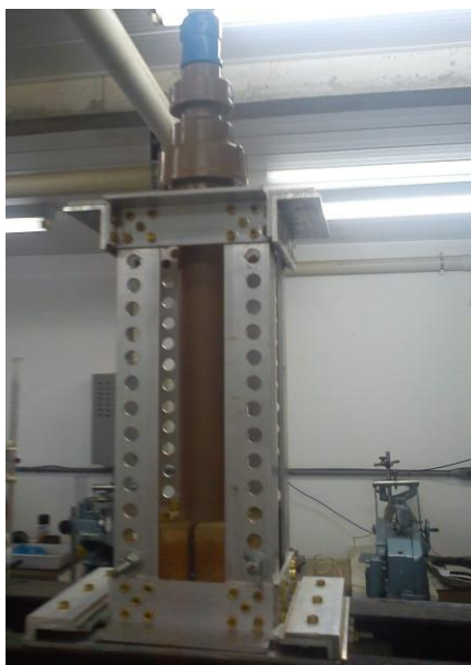
Figura 3.2 – Equipamento montado sobre o tanque para aplicação da carga.
