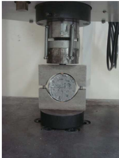
Figura 26 – Configuração do ensaio de resistência à tração por compressão diametral.
