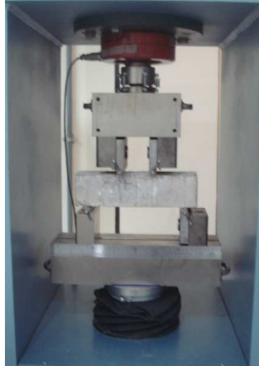
Figura 25 – Configuração do ensaio de resistência à tração na flexão.
