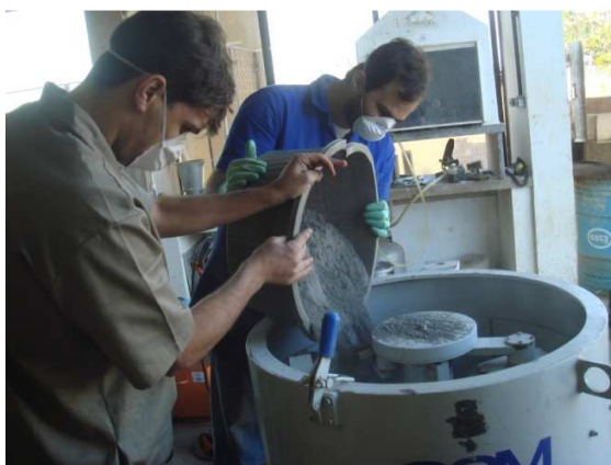
Colocação do cimento.
