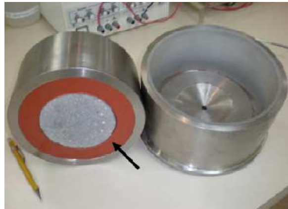
Figura 31 – Corpo-de-prova, para o ensaio de permeabilidade a gás, encaixado no anel de borracha de silicone.
