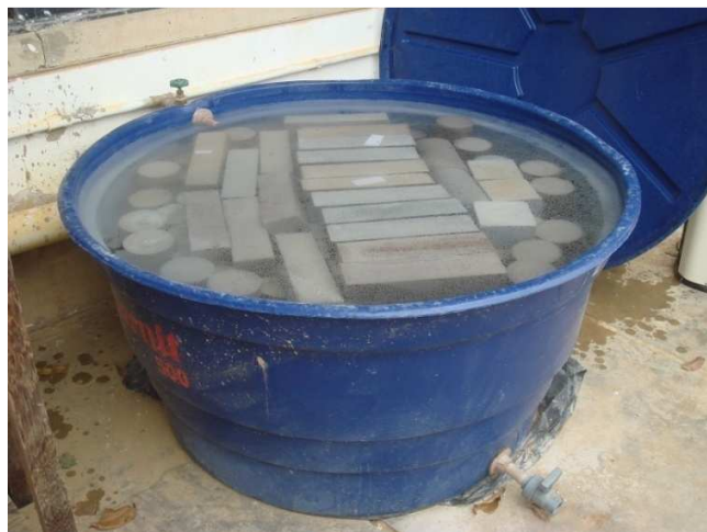
Figura 23 – Tanque de cura com corpos-de-prova e água saturada com cal.
