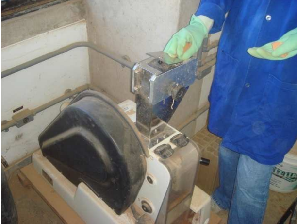
Figura 13 – RBC sendo cominuído no britador de mandíbulas.
