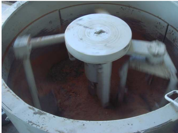
Homogeneização do cimento com o resíduo.
