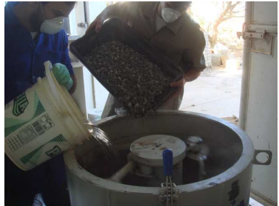
Colocação da brita e 70% da água.
