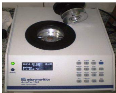
Figura 3.24 - Picnômetro a gás (He) do Laboratório de Materiais e Estruturas (LABEST/COPPE).
