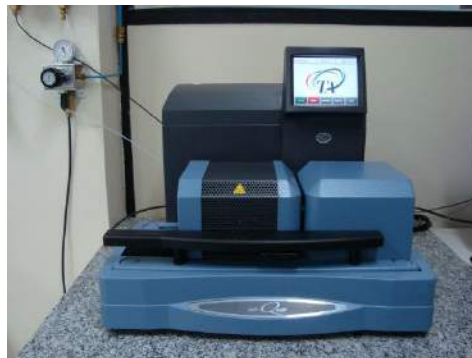
Figura 3.13 - Equipamento de termoanálise no Laboratório de Materiais e Estruturas da COPPE/UFRJ.
