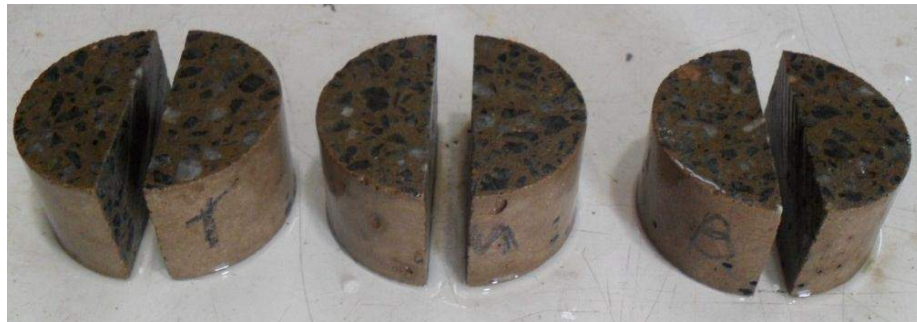
Figura 3.66 - Corpos de prova de C-CCE 600 para o ensaio de absorção de água por imersão.
