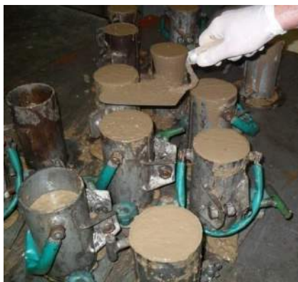
Figura 3.65 - Moldagem dos corpos de prova de concreto C-CCE 600.
