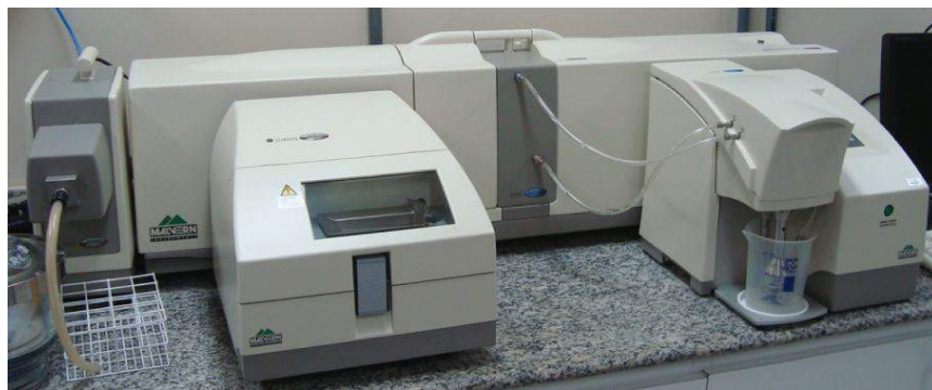
Figura 3.16 - Analisador de partículas a laser Mastersizer 2000 - Malvern Instruments®.
