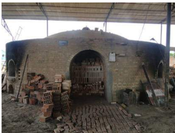
Figura 3.38 - Forno tipo abóboda da indústria cerâmica.
