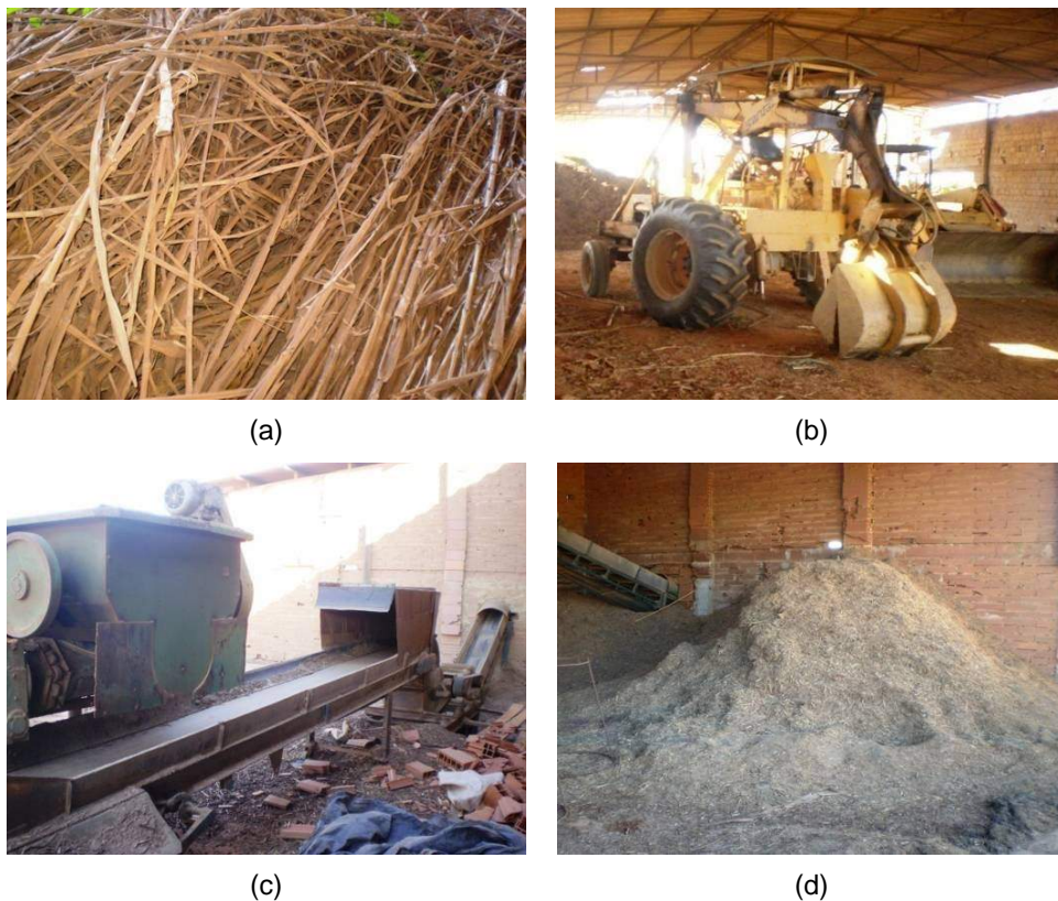
Figura 3.3 - Processamento e armazenamento do capim elefante na cerâmica União: capim seco (a); embarcadora (b); moinho de facas (c); armazenamento (d).
