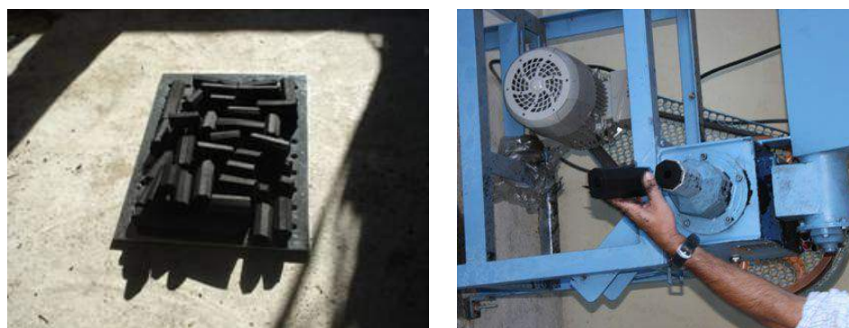
(a) (b) Figura 2.12 - Carvocapim (a); briquetização da biomassa (b) (ASCOM, 2012).
