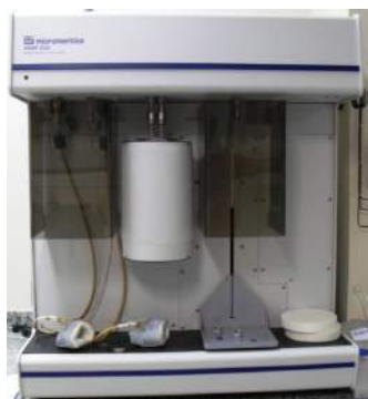
Figura 3.25 - Equipamento para BET ASAP 2020 da Micromeritics® do Laboratório de Materiais e Estruturas da COPPE/UFRJ.
