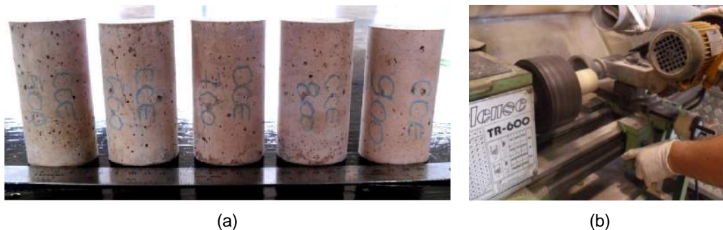
Figura 3.33 - Corpos de prova (a); corpo de prova sendo faceado em torno mecânico (b).
