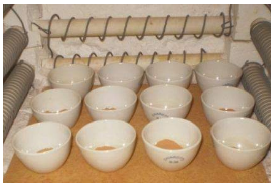
Figura 3.18 - Visão interna do forno no ensaio de perda ao fogo.
