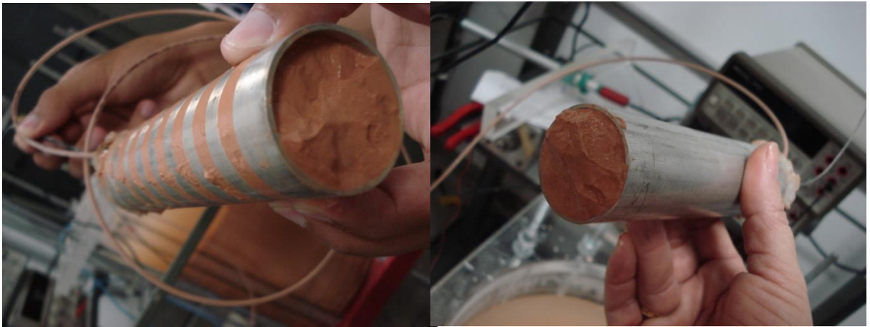
Figura 4.8 – Bucha de solo formada no interior das estacas.
