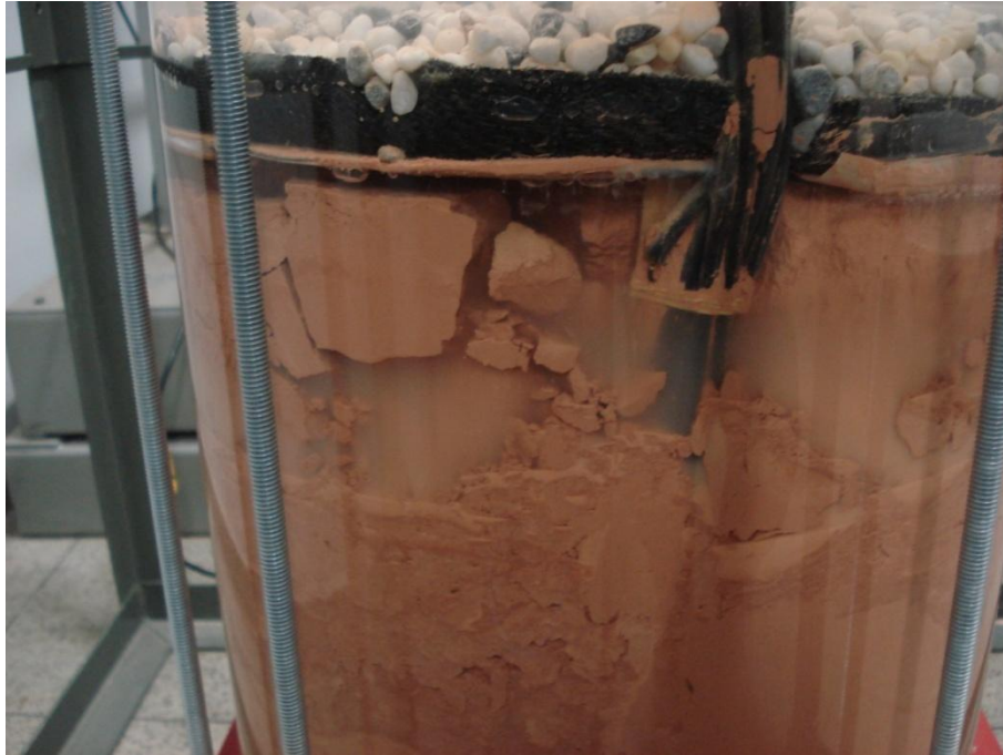
Figura 4.7- Solo após o adensamento por eletro-osmose com aquisição da resistividade.
