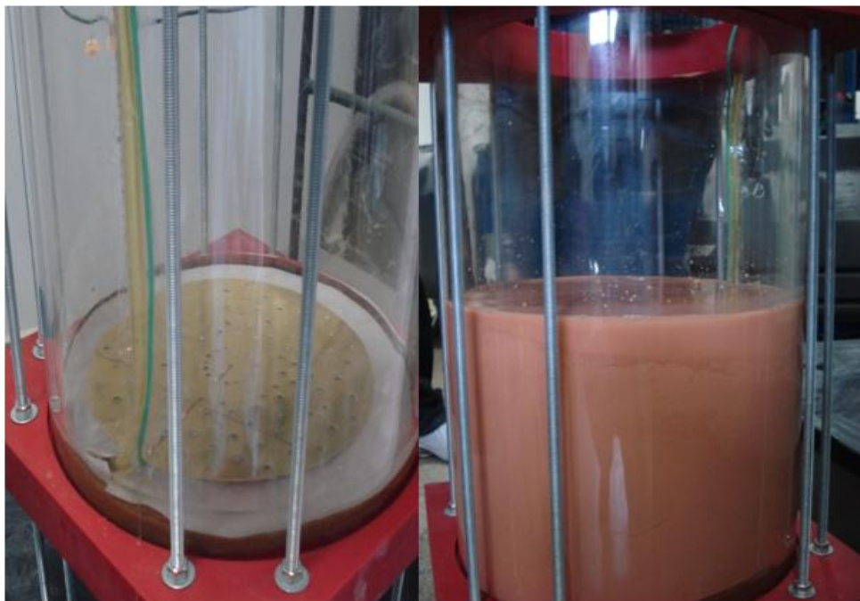
Figura 3.33 – Preparação da camada drenante e colocação do solo na caixa de acrílico.
