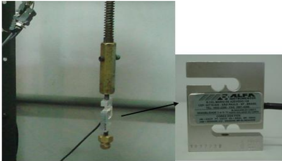
Figura 3.11 – Montagem da célula de carga – ensaios a 1 g.
