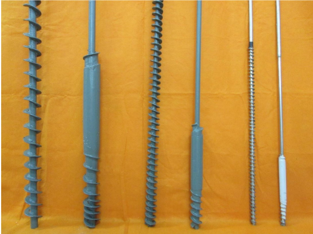
Figura 3.18: Modelos reduzidos dos trados de hélice contínua e ômega
