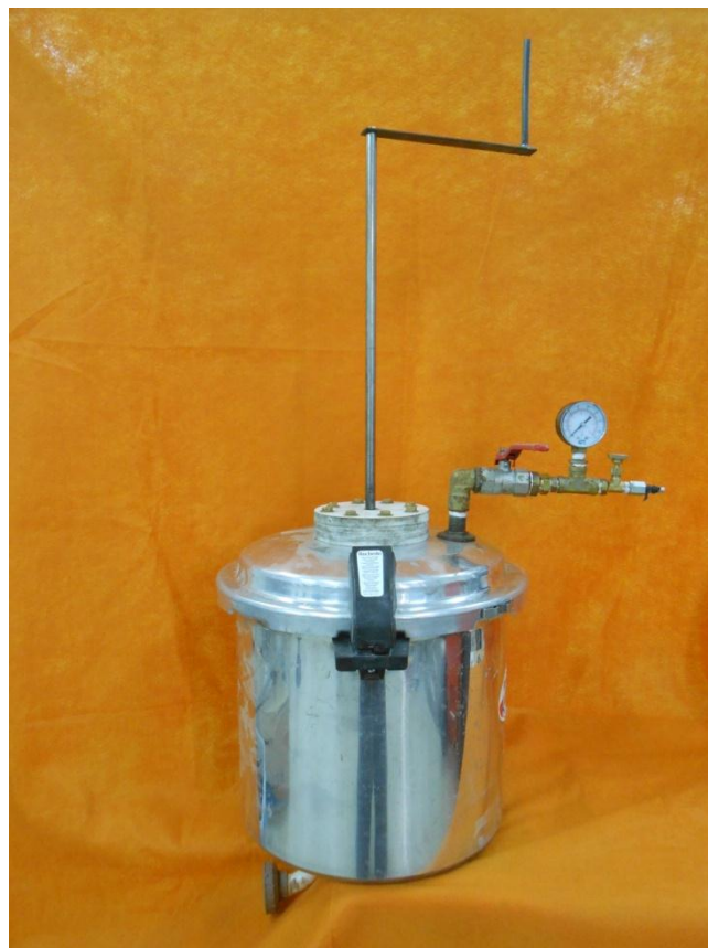
Figura 3.19: Sistema de injeção de argamassa
