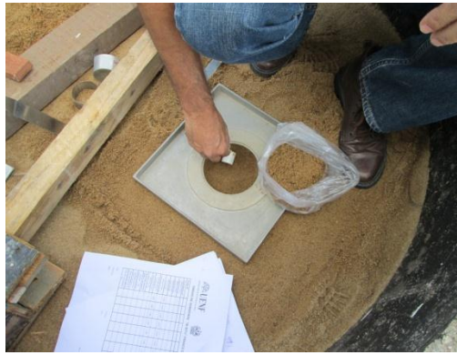
(a) Retirada do material
