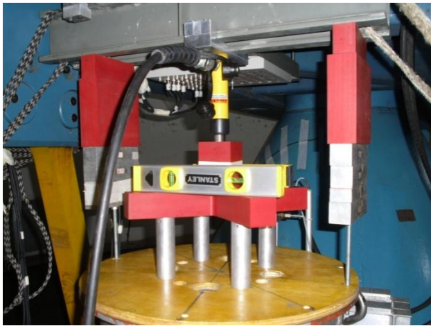
Figura 2. Sistema de Cravação das estacas.
