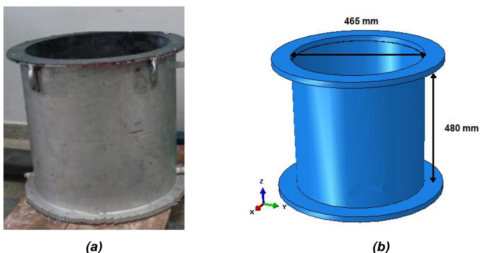
Figura 4.14-Caixa de teste cilíndrica de aço: (a) foto real da caixa e (b) esquema com as dimensões.
