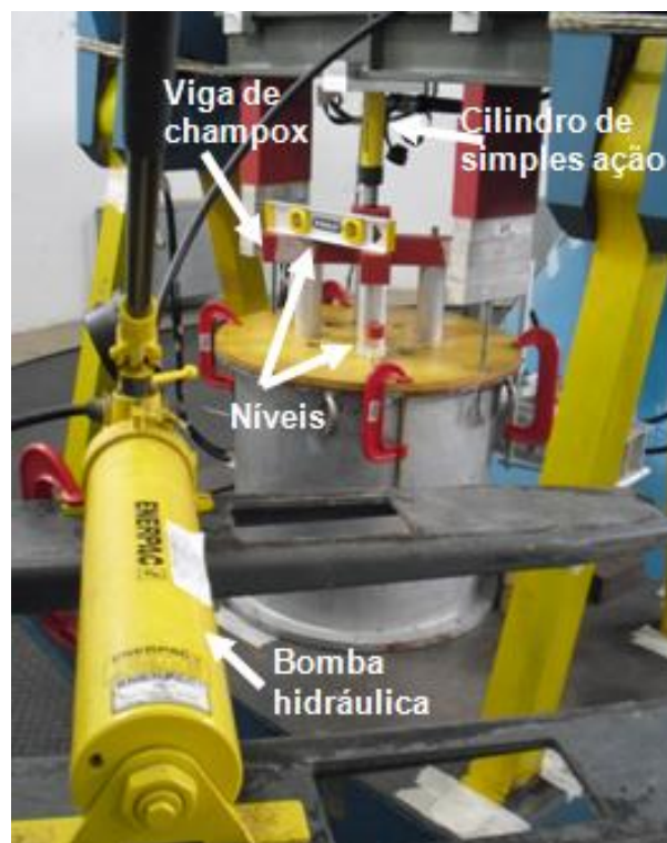
Figura 4.16 – Equipamentos utilizados para a cravação.
