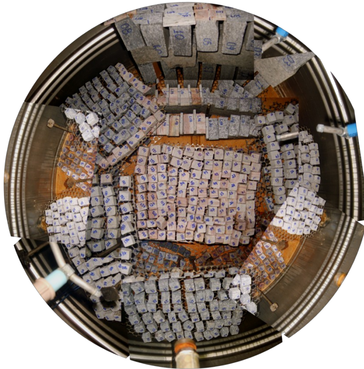
Figura 3.8: Vista interna do Equipamento de Degradação Universal da UENF com todas as amostras da degradação de laboratório.
