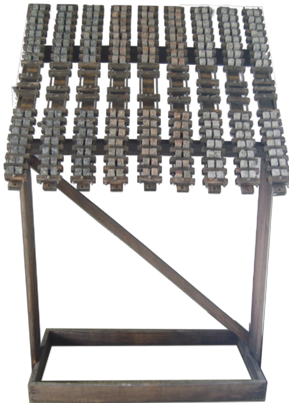
Figura 3.7: Painel de exposição de amostras a degradação natural no campo
