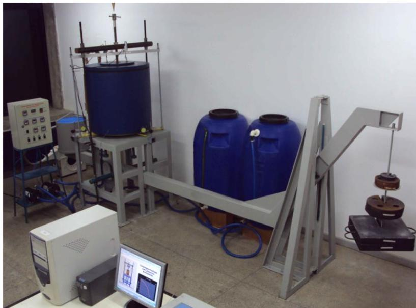
Figura 3.6: Equipamento de degradação acoplado ao equipamento de compressão confinada
