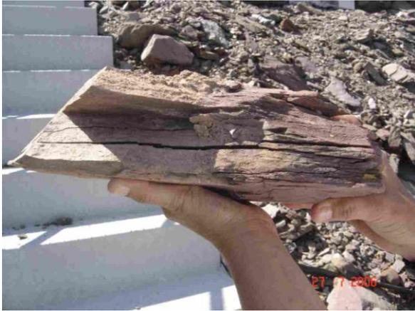
(a) Bloco em processo de degradação
