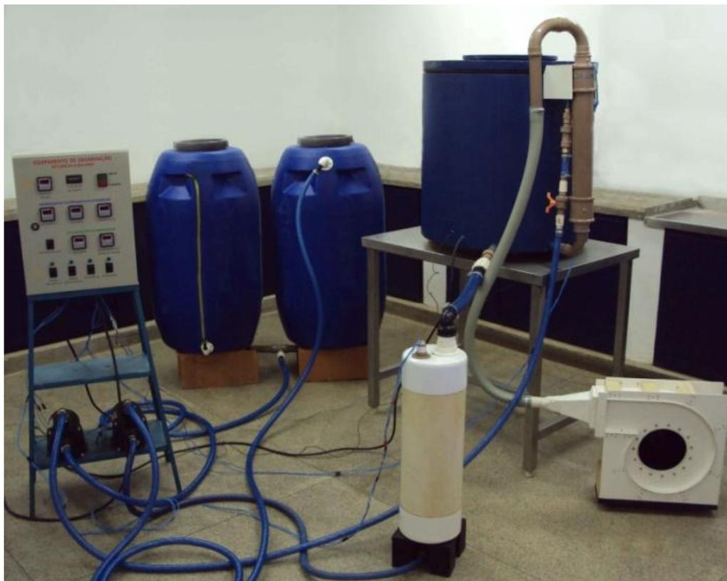
Figura 3.4: Vista do Equipamento de degradação por saturação e secagem da UENF
