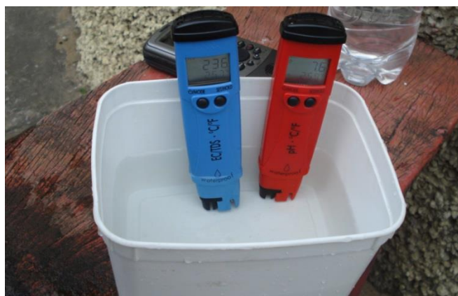
Figura 5-3 - Medição da condutividade elétrica, sólidos totais dissolvidos, pH e temperatura.
