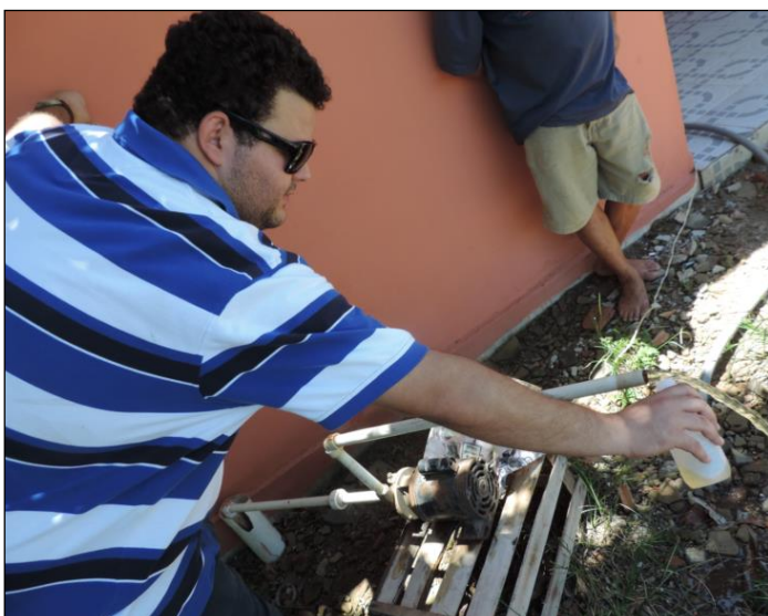
Figura 5-4 - Coleta de amostra em poço raso com bomba elétrica para análise laboratorial. É possível ainda observar o recipiente da análise físico-química.
