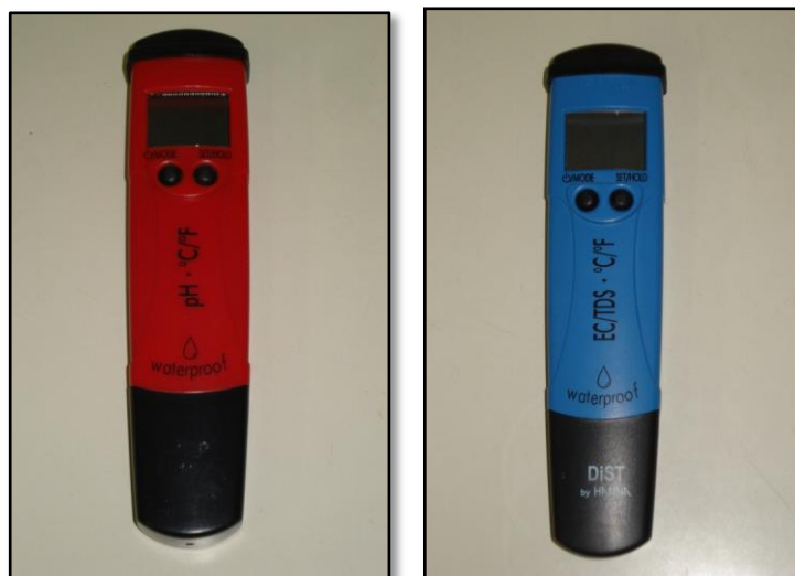
Figura 5-1 - GPS, medidor de nível d'água, de pH, de condutividade elétrica, sólidos totais dissolvidos e termômetro.
