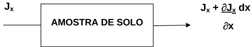
Figura 3.1 – Balanço de massa em uma amostra de solo.
