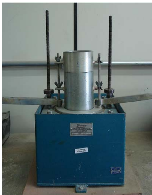
Figura 5.3 – Esquema utilizado para a obtenção do índice de vazios mínimo da amostra 3.
