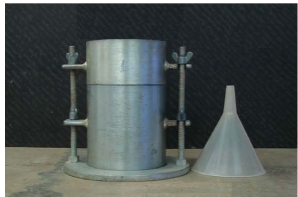
Figura 5.2 – Molde e funil utilizados nos ensaios de determinação de índice de vazios máximo.
