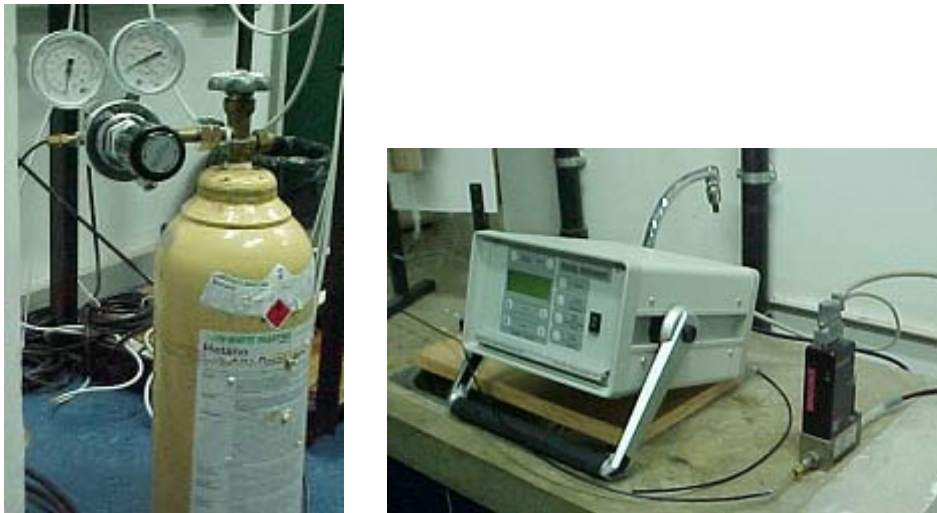
Figura 5.8 – Balão de gás e fluxômetro.
