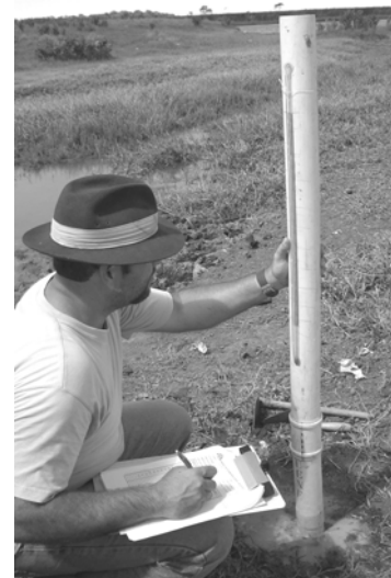
Figura 4.16 Ensaio de permeabilidade in situ
