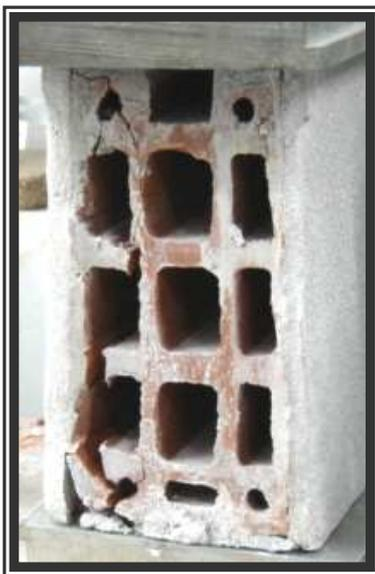
Figura 5.10 – Ruptura de todos os septos horizontais a esquerda
