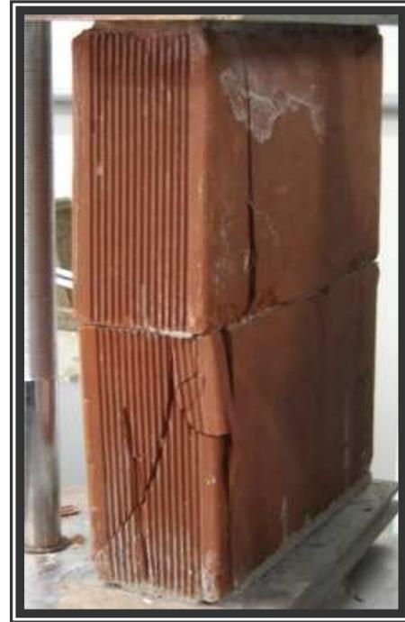
Figura 5.26 - Aumento nas aberturas das fissuras e o aparecimento de outras
