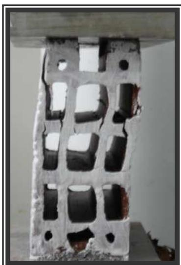
Figura 5.6 - Aumento nas aberturas das fissuras
