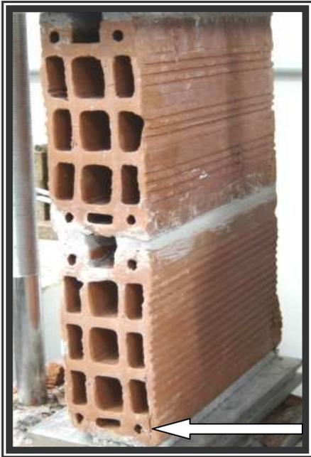
Figura 5.17 - Ruptura do prisma no canto inferior direito
