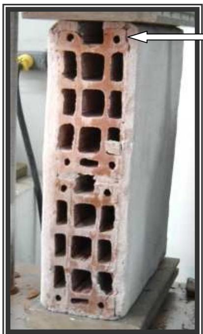
Figura 5.21 - Ruptura do prisma no septo superior
