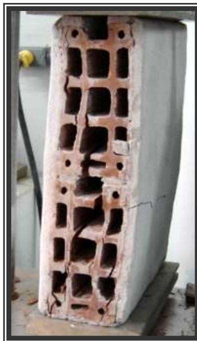
Figura 5.24 - Colapso do prisma
