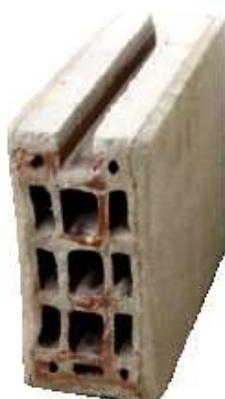
Figura 5.2 - Bloco emboçado
