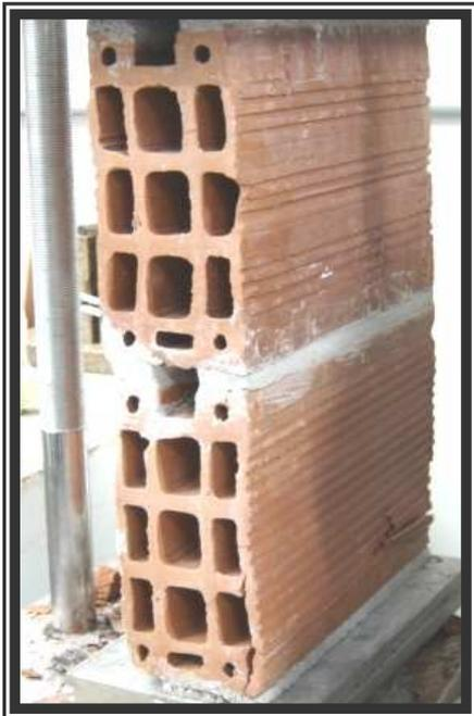
Figura 5.19 - Aumento das aberturas e deformação da parede lateral
