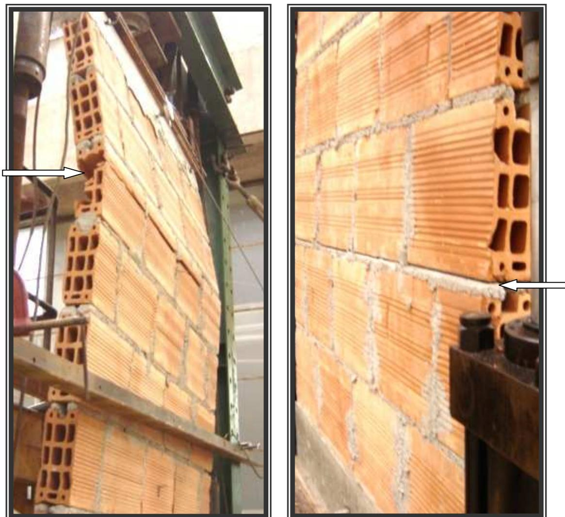
Figura 5.31 – Ruptura no septo horizontal do bloco e o tombamento da parede a partir da segunda fiada
