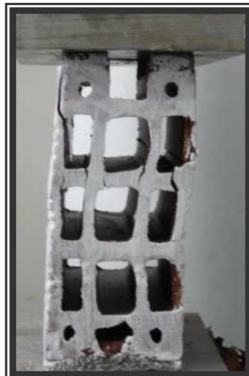
Figura 5.5 - Aumento do número de fissuras no bloco no bloco
