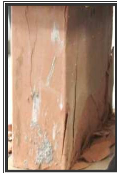
Figura 5.15 - Registra o colapso total do bloco
