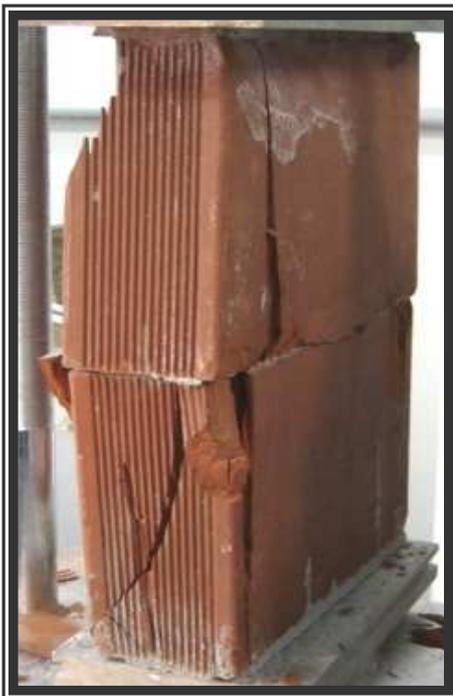
Figura 5.27 - Colapso do prisma
