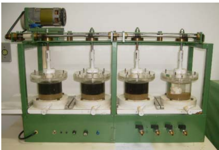
Figura 19 - Esquema do ensaio de difusão.
