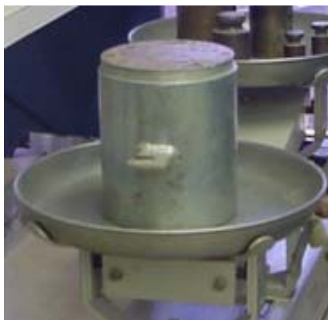
Figura 14 - Corpo de prova compactado para ensaio de permeabilidade.
