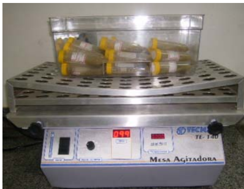
Figura 17 - Mesa agitadora (laboratório de geotecnia ambiental, DEC_UFV).
