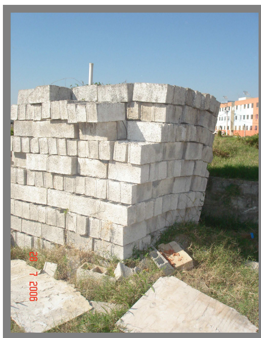
Figura 13 – Acabamento dos blocos estruturais - obra E
