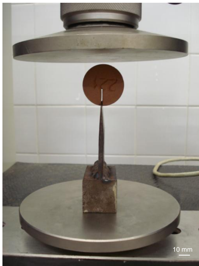
Figura 3.18 – Disposição do corpo de prova na cunha para o ensaio de cunha.
