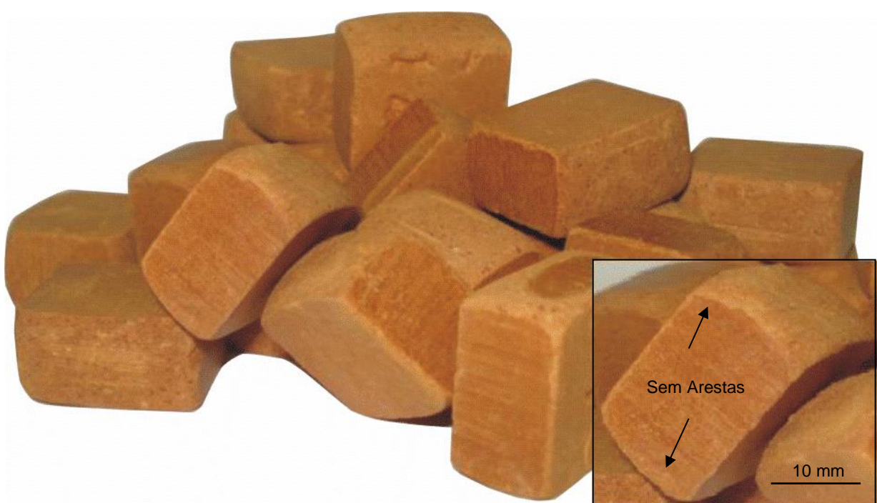
Figura 3.4 – Material de ensaio micro deval; Detalhe: sem arestas.
