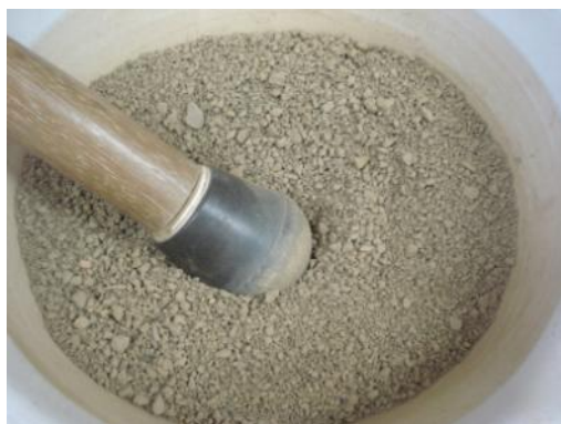
Figura 4.5 – Material destorroado com auxílio de mão de gral e almofariz.
