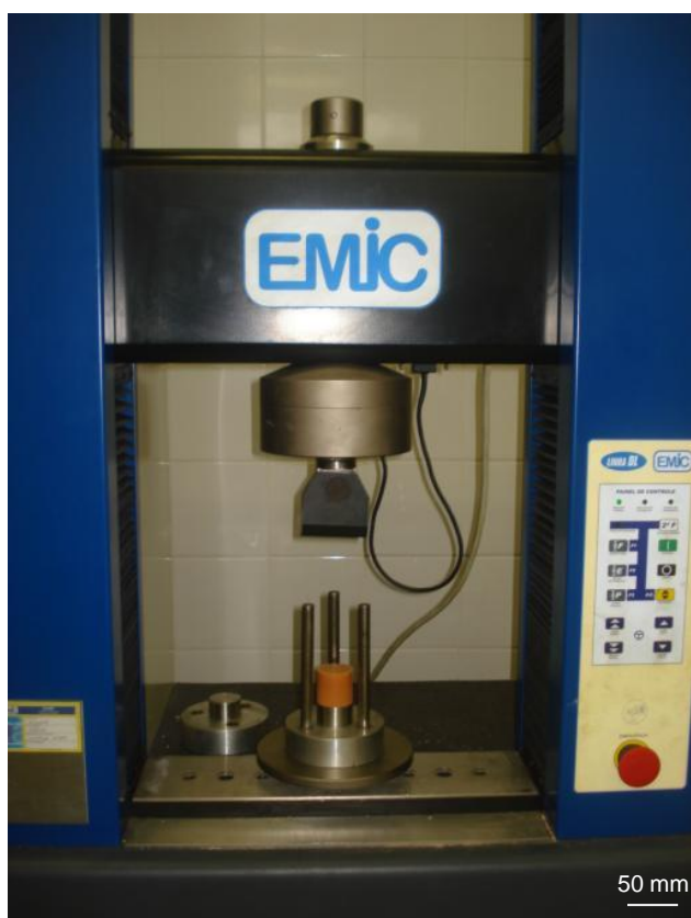
Figura 3.12 – Disposição da base e corpo de prova para o ensaio de resistência à tração pelo ensaio de compressão uniaxial.
