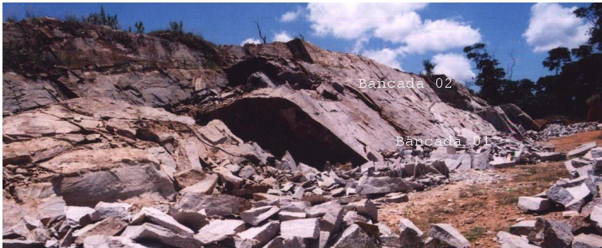
Figura 17- Vista geral das duas bancadas da lavra de “Pedra Madeira” mostrando a região de uma descontinuidade que entra no talude causando uma ruptura lateral.
