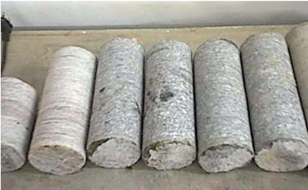
Figura 41- Corpos de Prova logo após a retirada com a perfuratriz rotativa (sem acabamento).
