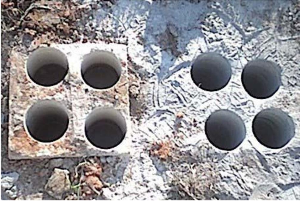
Figura 40- Blocos “furados” após a retirada dos corpos de prova com a perfuratriz rotativa.
