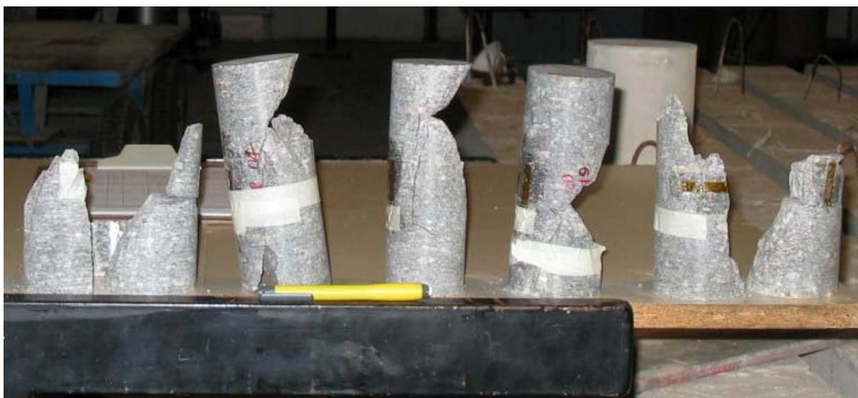
Figura 44- Corpos de Prova do Olho de Pombo rompidos após a realização do ensaio.
