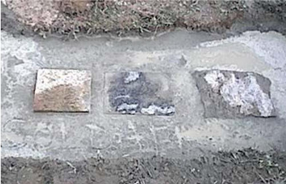
Figura 39- Blocos retirados das pedreiras e concretados no solo para a posterior remoção dos corpos de prova com a perfuratriz rotativa.
