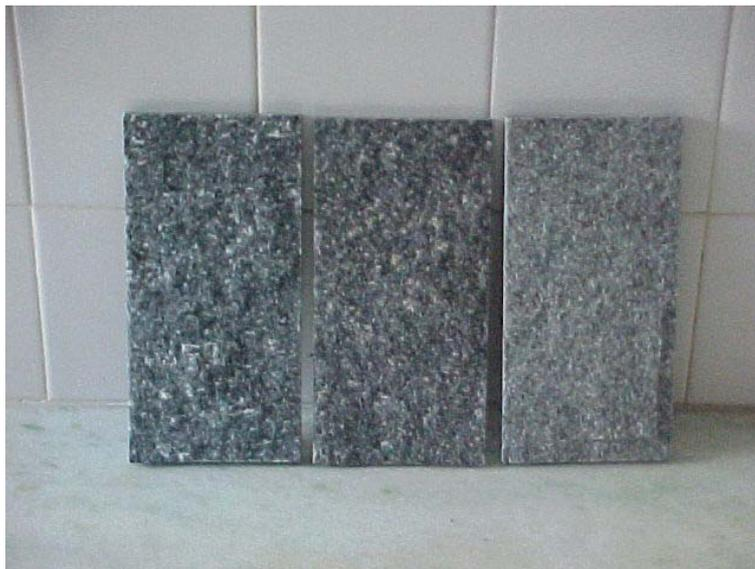
Figura 05- Da esquerda para a direita, placas de “granito” olho-de-pombo, pinta rosa e “granito” fino (dimensões- 23x11x1,5 cm).
