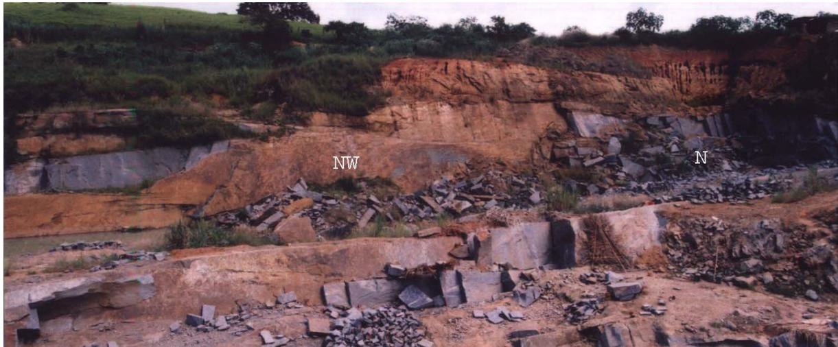
Figura 14- Vista geral das duas bancadas da lavra de “granito” olho de pombo (pedreira estudada), mostrando faixas de contato solo/rocha alterada/rocha sã (de cima para baixo) e a região dos setores N e NW.
