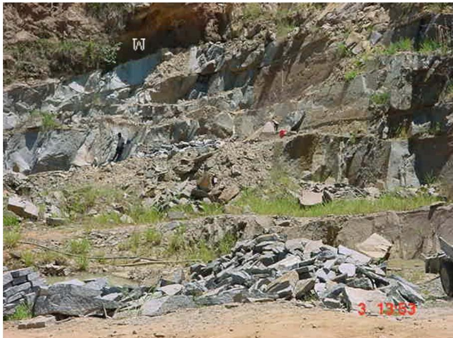
Figura 15- Vista parcial de lavra de “granito” olho de pombo,mostrando porção alterada do maciço e juntas de alívio. Região do setor W.
