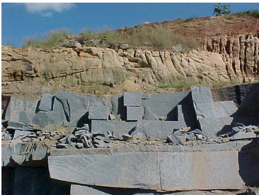
Figura 08- Vista parcial de lavra de “granito” olho de pombo, mostrando espessura da capa de solo sobre a lavra, onde a mesma já se encontra em processo erosivo com a formação de ravinas.
