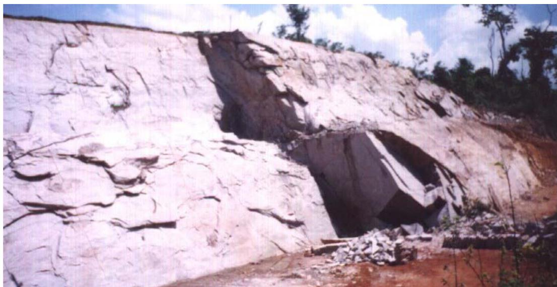
Figura 09- Vista parcial do lado direito da lavra de “pedra madeira rosa” (porção SW), mostrando corte realizado com flame-jet (a direita) e a xistosidade do material no sentido da inclinação de mergulho do talude. Observe a inexistência de camada de solo sobre o maciço.
