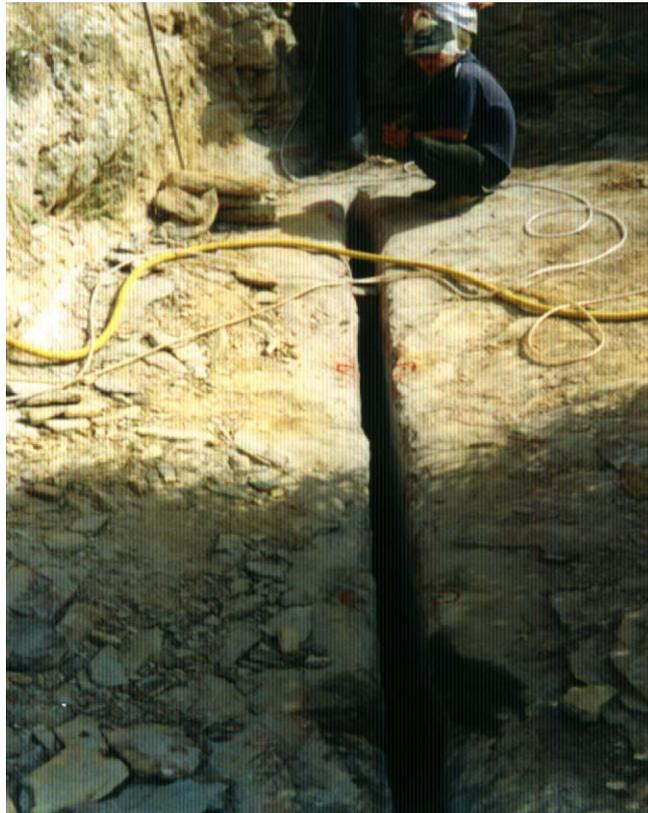
Figura 27- Corte executado com *Flame Jet* na Pedreira Olho de Pombo.
