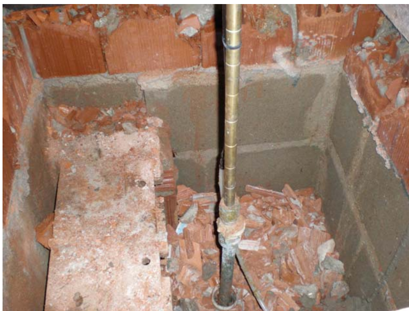
Figura 3.5 – Marco de referência com a haste metálica graduada.
