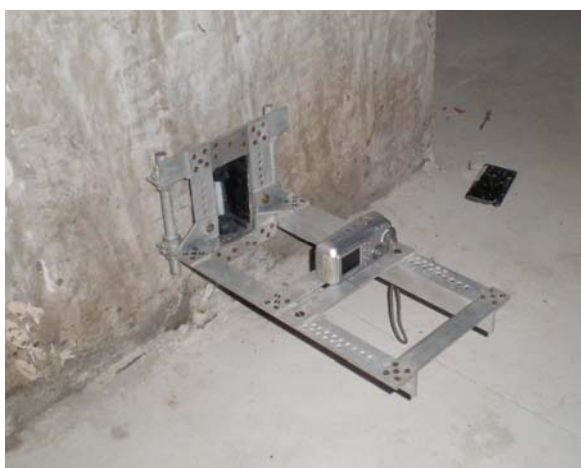
Figura 3.11 – Leitura de nível nos pilares
