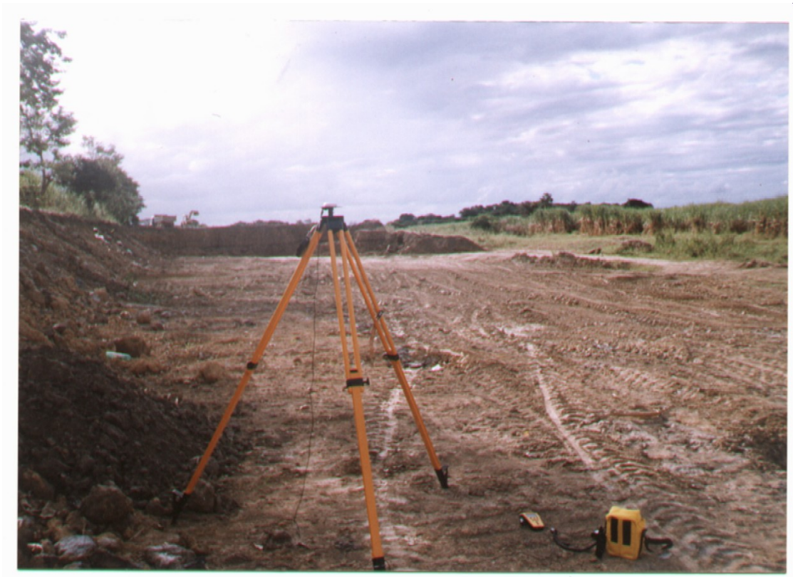
Figura 3.3 – Aparelho de GPS Geoexplorer II com antena externa fixada em um tripé de teodolito.
