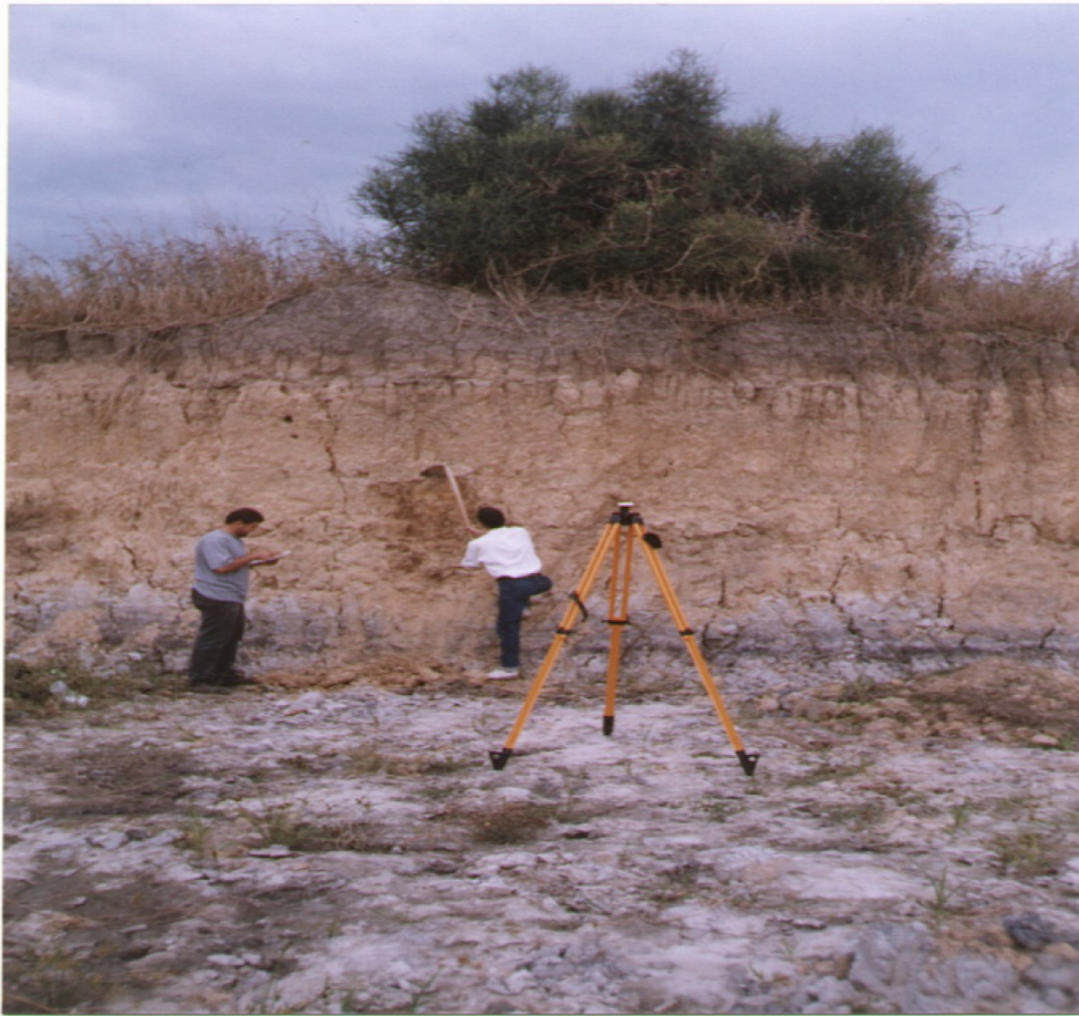
Figura 3.1 – Limpeza e obtenção de amostras do perfil. Em frente, o tripé da antena do G P S.
