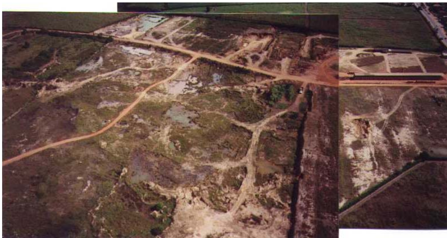
Figura 1.3 – Vista aérea de uma área de exploração, nota-se a interrupção da exploração ao se atingir o lençol freático.
