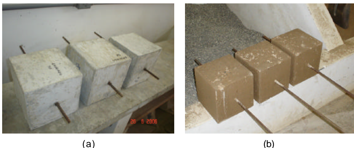
Figura 4.7 - Corpos-de-prova prismáticos (200 x 200 x 200) mm: (a) concreto de cimento Portland; (b) concreto de cimento geopolimérico.
