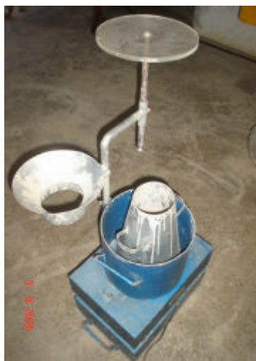
Figura 4.6 - Equipamento para medir a consistência (tempo Vebe) da mistura fresca dos concretos de cimento Portland e de cimento geopolimérico.
