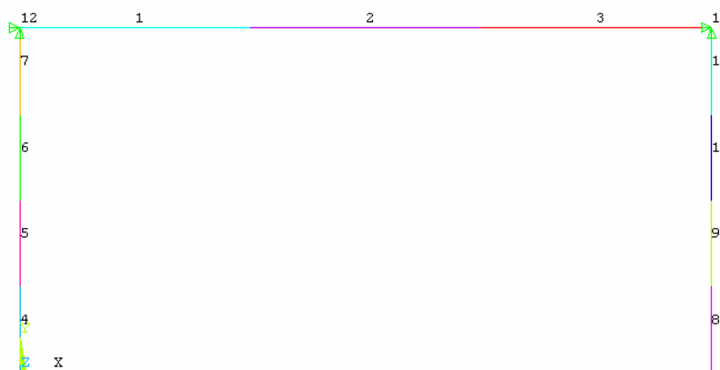
Figura 18 – Pórtico 1: malha de elementos finitos
