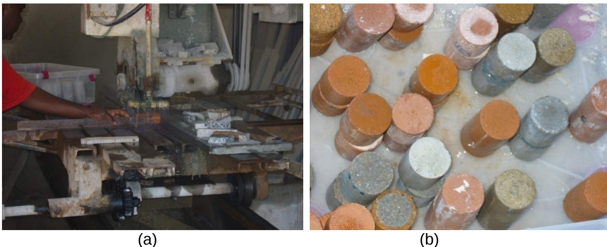
Figura 3.5 - (a) Corte de um corpo-de-prova. (b) Corpos-de-prova cortados em partes iguais.
