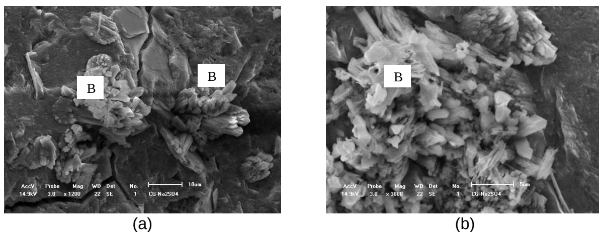
Figura 4.31 - Imagens no MEV da pasta geopolimérica na ciclagem em sulfato de sódio com aumento de: (a) 1200x; (b) 3000x. B - barrilha ou natrão.
