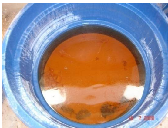
Figura 4.10 - Aspecto visual do tanque de cura dos corpos-de-prova da AG após o 8.º ciclo agressivo.
