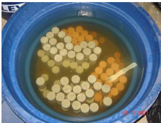
Figura 4.9 - Aspecto visual do tanque de cura dos corpos-de-prova de AC e AG após 2 meses em ciclagem agressiva em conjunto.
