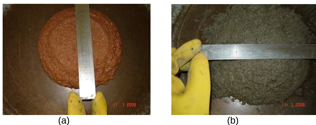
Figura 3.4 - (a) Ensaio de consistência da argamassa geopolimérica (b) e da argamassa convencional.
