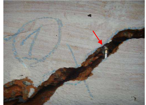
Figura 7.7 - Viga 4 (a) Detalhe da ruptura (b) Ruptura do estribo
