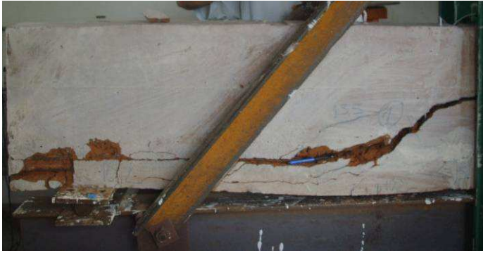
Figura 7.7 - Viga 4 (a) Detalhe da ruptura (b) Ruptura do estribo
