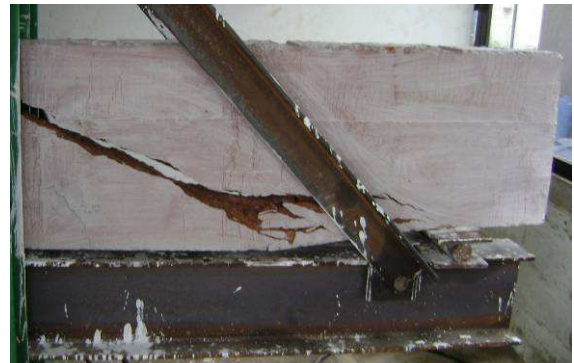
Figura 7.2 - Viga de referência (a) fissuras diagonais (b) Ruptura
