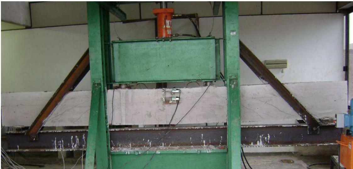
Figura 7.5 - Viga 3: Detalhe da formação das fissuras
