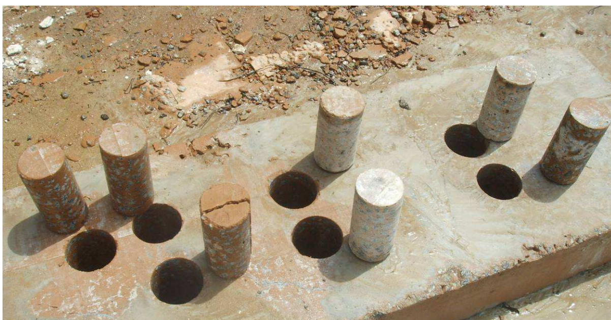
Figura 3.7 - Retirada dos corpos de prova das vigas.
