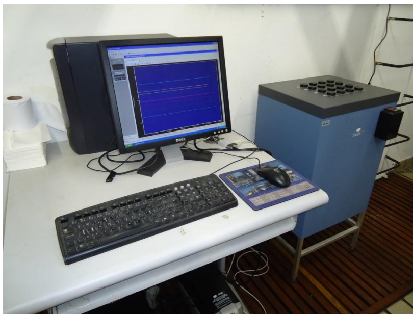
Figura 3.21 - Calorímetro de condução isotérmico do Instituto de Pesquisas Tecnológicas de São Paulo (IPT).
