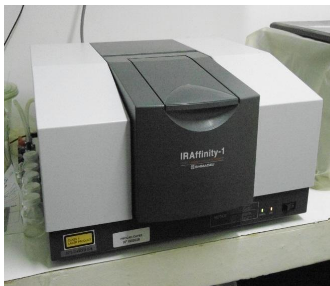
Figura 3.9 - Espectrômetro IRAffinity-1 com acessório ATR do Laboratório de Química da UENF utilizado para os ensaios de espectroscopia no infravermelho.
