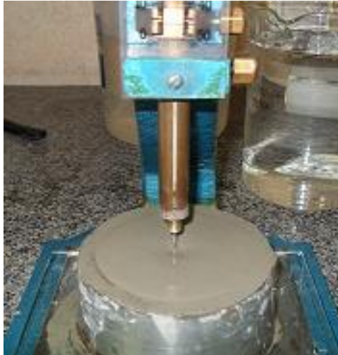
Figura 3.13 - Penetração da agulha de Vicat durante o ensaio de pega.
