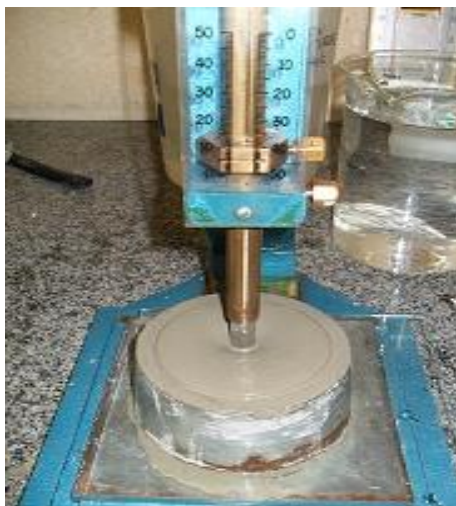
Figura 3.12 - Penetração da sonda Tetmajer durante o ensaio de consistência normal.
