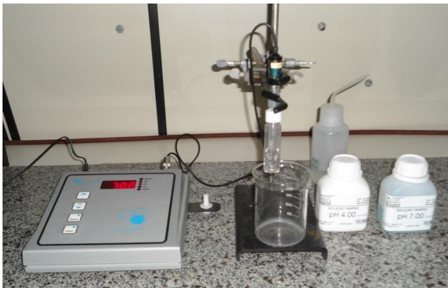
Figura 3.11 - Aparatos utilizados para medição do pH das cinzas.
