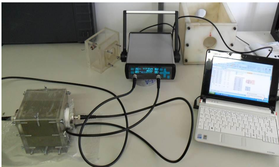
Figura 3.15 - Aparato utilizado nos ensaios de variação de velocidade ultrassônica.
