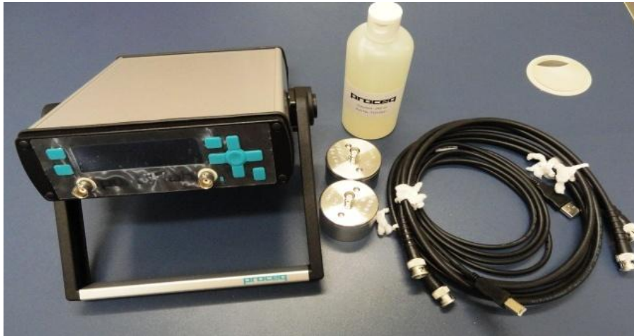
Figura 3.14 - Medidor de pulso ultrassônico do LECIV/UENF.
