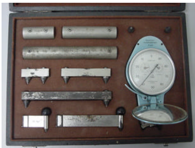
Figura 3.7 – Tensotast e seus gabaritos
