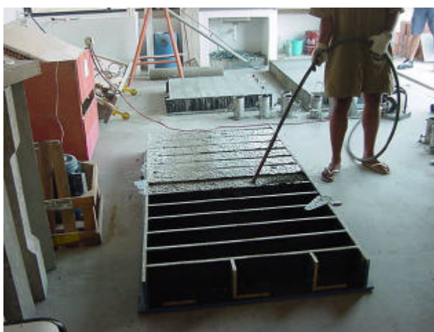
Figura 3.4 – Concretagem dos corpos de prova prismáticos
