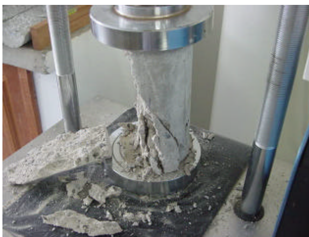
Figura 3.14 – Ensaio mecânico de compressão uniaxial para os corpos de prova cilíndricos
