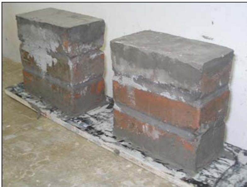
Figura 3.11 – Prismas preparados para ensaio
