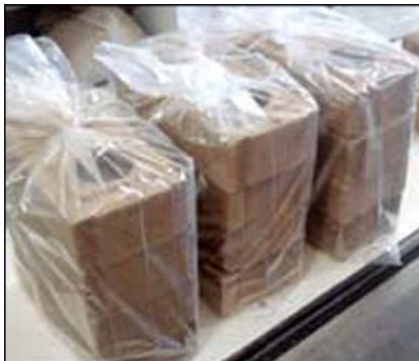
Figura 4.2 – Blocos empacotados para não perderem a umidade
