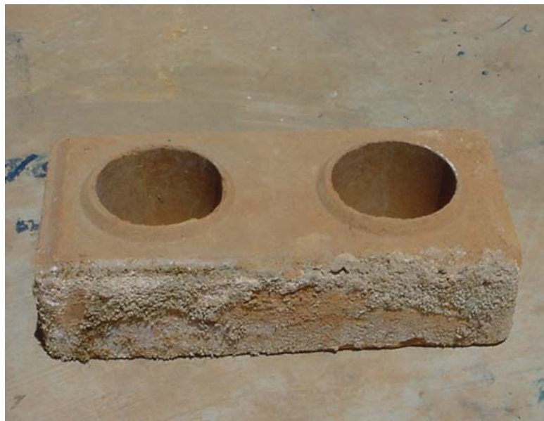
Figura 2.12 – Formação de eflorações e fungos no bloco
