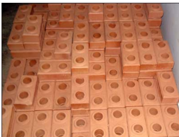
Figura 4.5 – Blocos prensados e queimados ETAPA-PMANUAL
