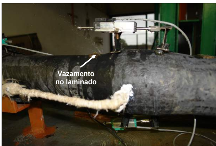
Figura 91 – Vazamento no laminado do corpo-de-prova CPE1L85.
