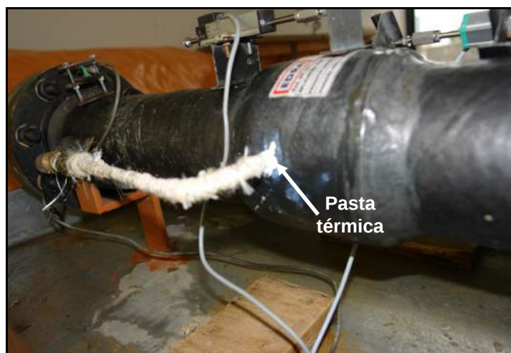
Figura 51 – Posicionamento do TCT e detalhe da utilização de pasta térmica.
