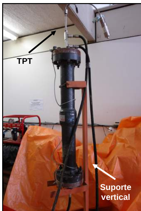
Figura 46 – Corpo-de-prova no suporte de saturação.
