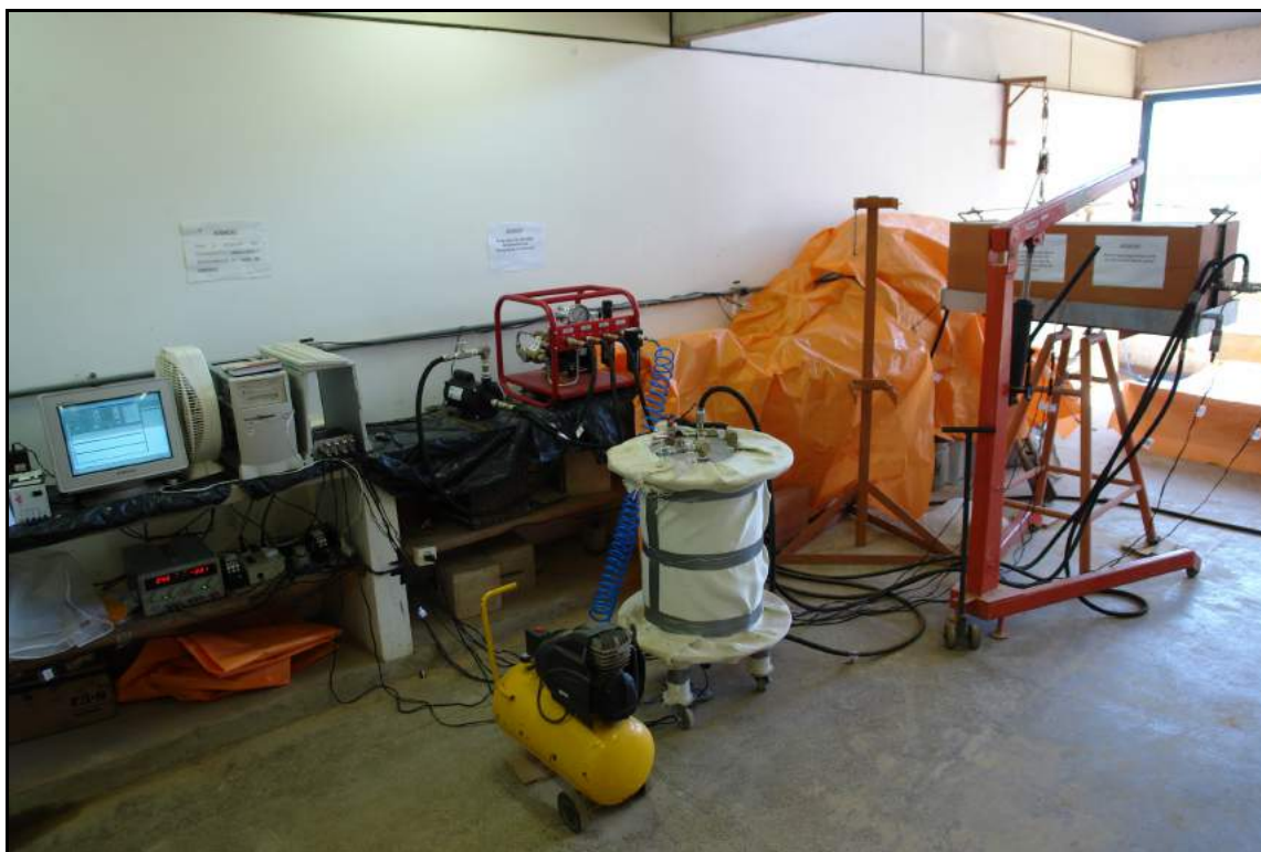
Figura 27 – Vista panorâmica do equipamento de ensaio hidrostático com variação de temperatura.
