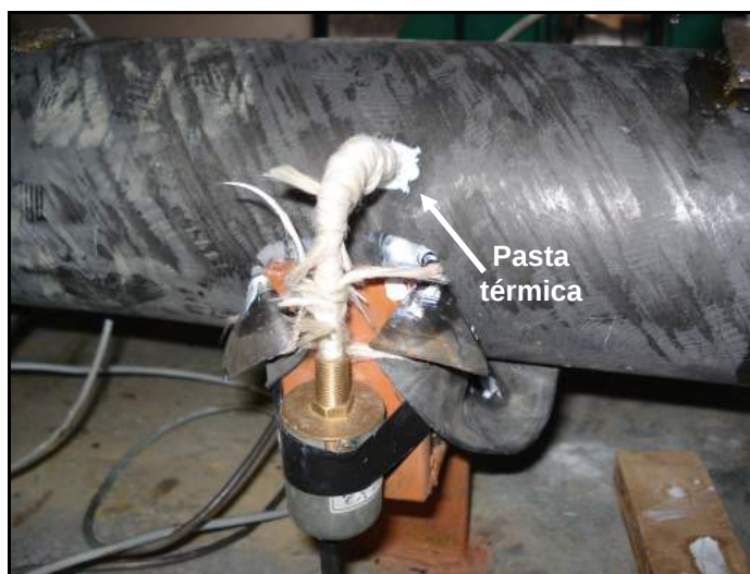
Figura 52 – Posicionamento do TCTA no corpo-de-prova e detalhe da utilização de pasta térmica.
