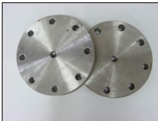
Figura 45 – Flanges cegos de aço com orifício central para passagem de água.
