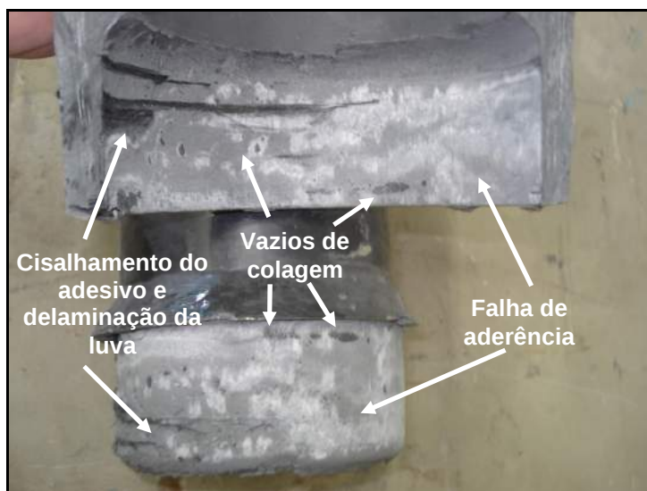
Figura 84 – Superfície de ruptura do corpo-de-prova CPE1C85.
