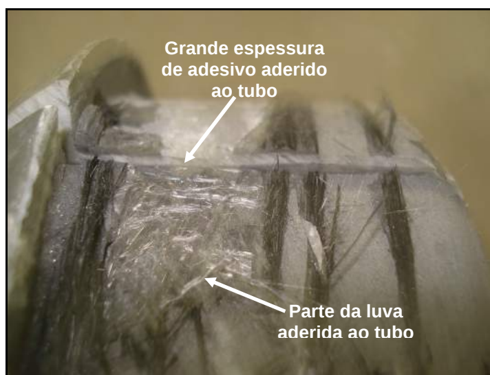
Figura 86 – Superfície de ruptura da luva do corpo-de-prova CPE1C85.
