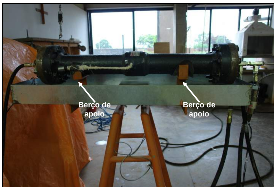
Figura 105 – Deposição do corpo-de-prova no suporte horizontal.
