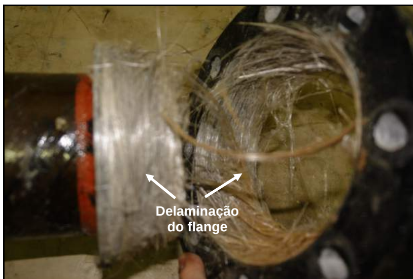
Figura 92 – Delaminação do flange no corpo-de-prova CPA1C85.
