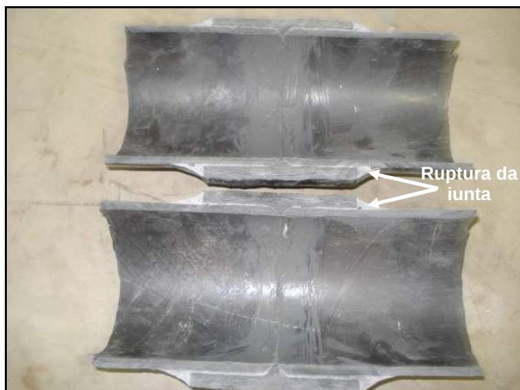
Figura 89 – Região de ruptura do corpo-de-prova CPE3C85.
