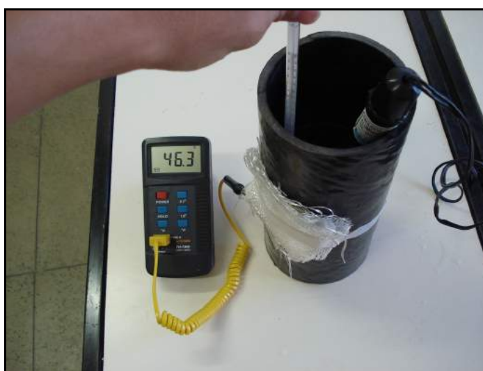
Figura 53 – Estimativa de tempo de estabilização de temperatura na parede de um setor de tubo de PRFV do fabricante nacional.
