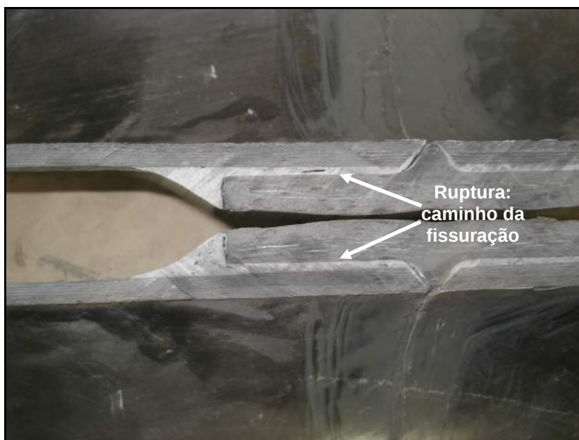
Figura 90 – Caminho de fissuração na região fraturada do corpo-de-prova CPE3C85.
