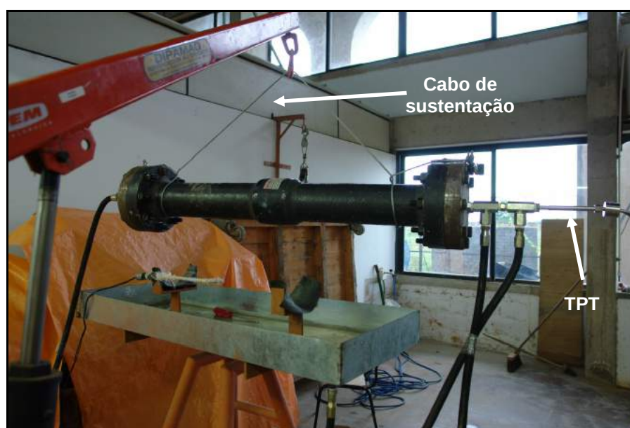
Figura 101 – Detalhes de fixação de cabo de sustentação e da conexão do transdutor de pressão e temperatura (TPT) no corpo-de-prova.
