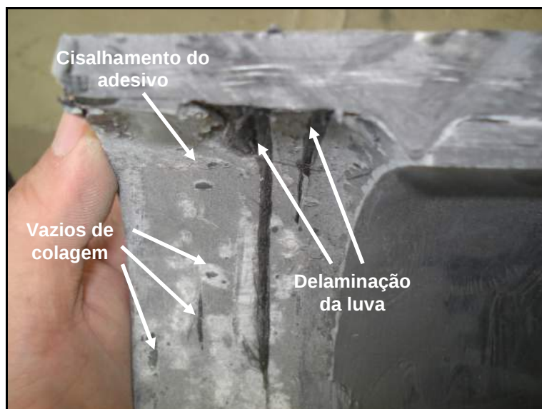
Figura 85 – Superfície de ruptura da luva do corpo-de-prova CPE1C85.
