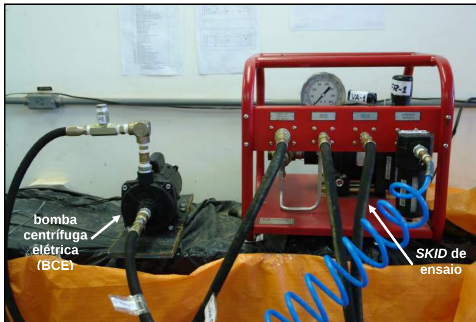
Figura 31 – Bomba centrífuga elétrica e SKID de ensaio hidrostático.
