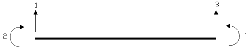
Figura 6 – Elemento de viga e numeração dos graus de liberdade
