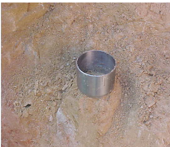
(c) Moldagem com amostrador cilíndrico de aço para ensaios de compressão oedométrica.
