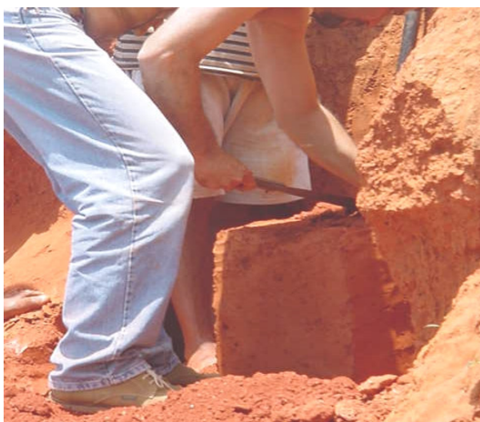
(a) Moldagem do bloco no terreno.
