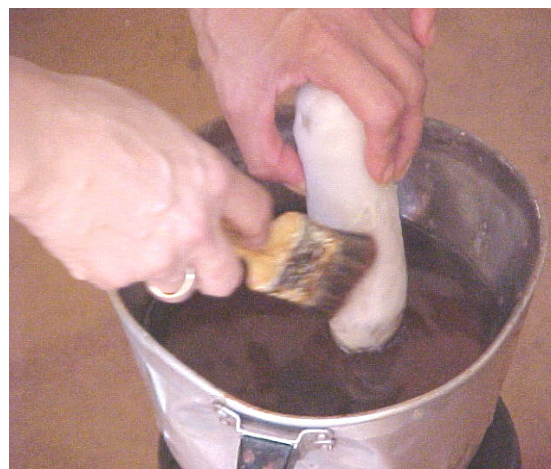
(d) Condicionamento com filme PVC e parafina.
