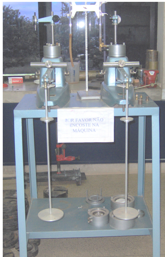
Figura 5.6 - Prensa Wykeham-Farrance utilizada no ensaio de compressão oedométrica.
