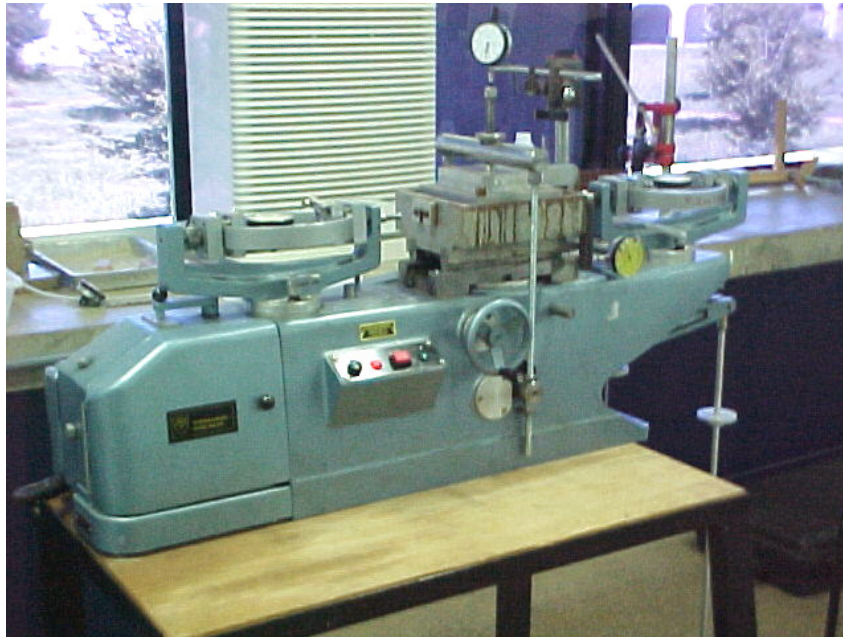
Figura 5.5 - Prensa Wykeham-Farrance adaptada para o ensaio de cisalhamento direto com reversão.
