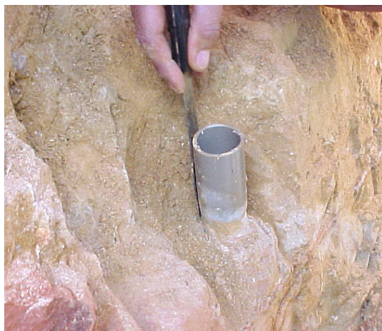
(a) Moldagem com amostrador cilíndrico de PVC para ensaios de compressão triaxial.
