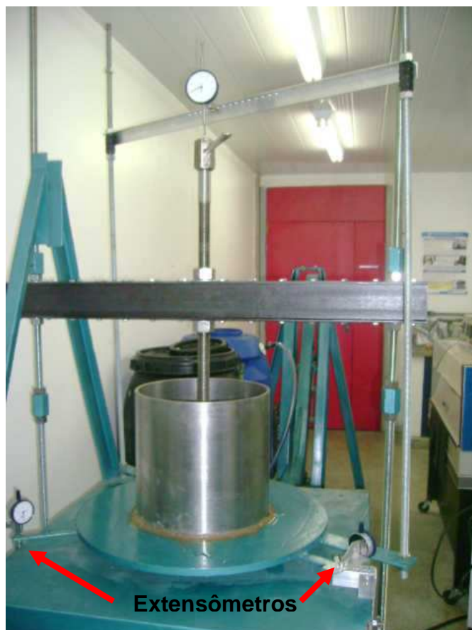
Figura 3.6 - Detalhe dos extensômetros.
