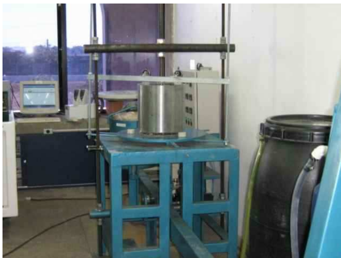
Figura 3.9 – Pórtico de transmissão de carga.
