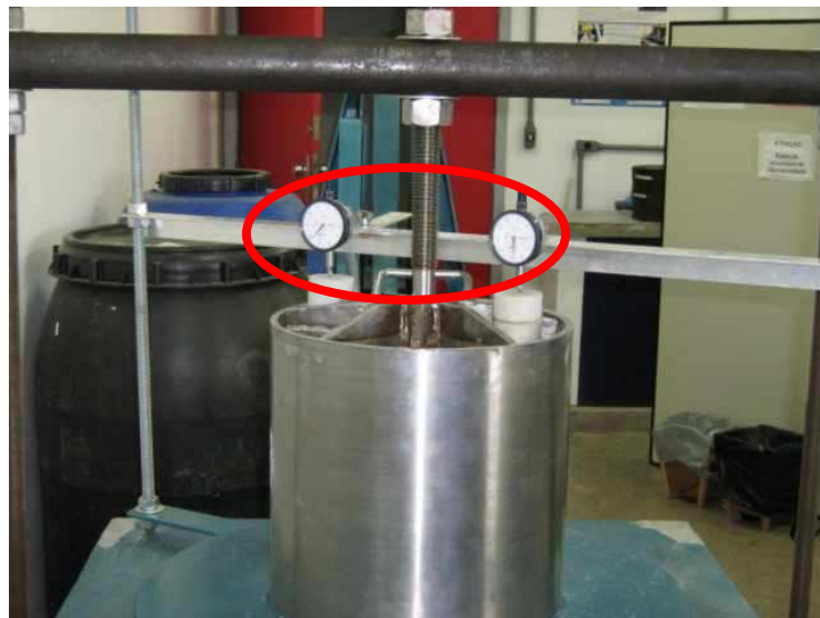
Figura 3.14 – Extensômetros para medição dos deslocamentos verticais.
