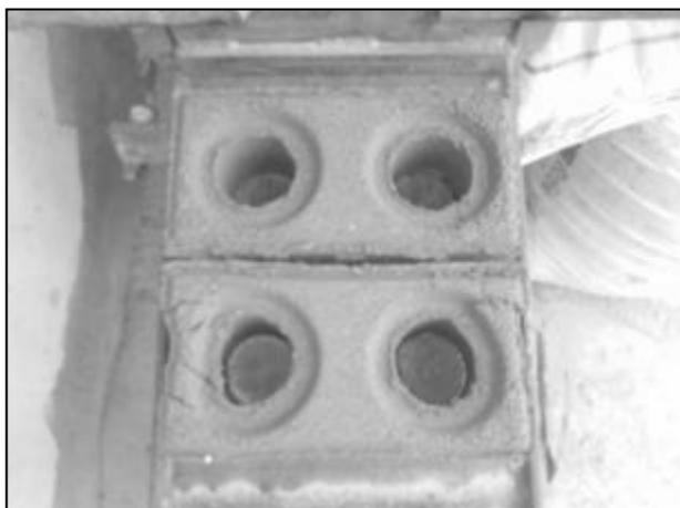
**Figura 3.3 - Tentativa de moldagem dos blocos com 9,7% de umidade para o traço (10:40:50)**
