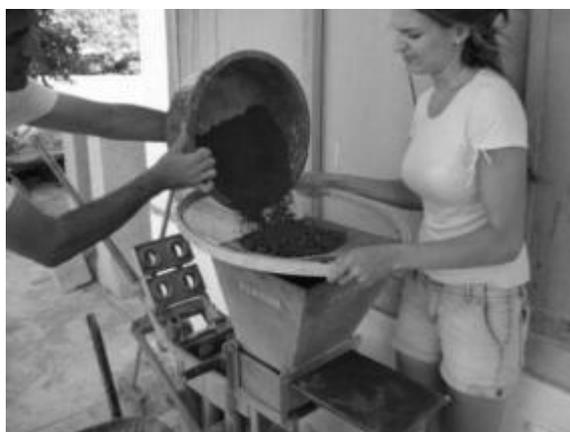
**Figura 3.6 - Lançamento da mistura na cuba da prensa passando antes por peneiramento para destorroar os grumos**
