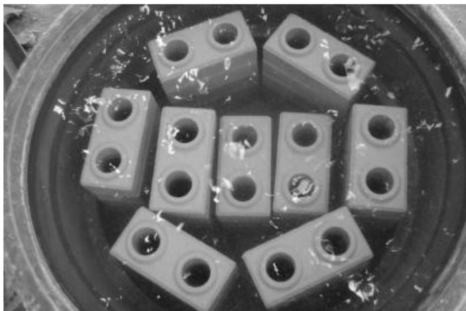
**Figura 3.9 - Detalhe dos blocos em cura úmida**
