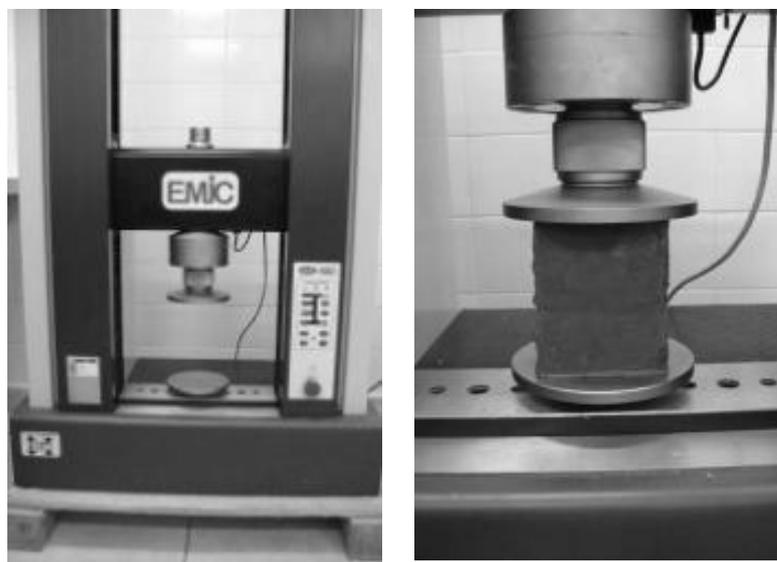
**Figura 3.13 - Ensaio de Resistência à Compressão**
