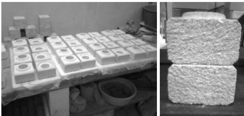
**Figura 3.11 – Preparação dos blocos para o capeamento (a) Blocos serrados, (b) Bloco serrado formando prisma**
