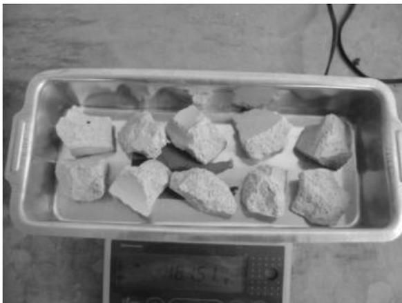
**Figura 3.16 - Peças de um traço de bloco preparadas para o ensaio**
