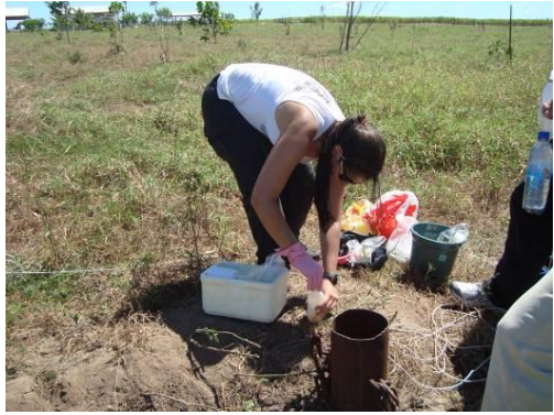
Figura 5.7 – Adicionando ácido nítrico no recipiente da análise físico-química.
