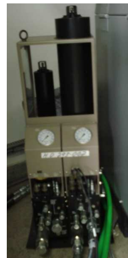
Figura 3.28. Unidade HPU-MTS- a) controlador 407 MTS, b) bomba hidráulica, c) manifold
