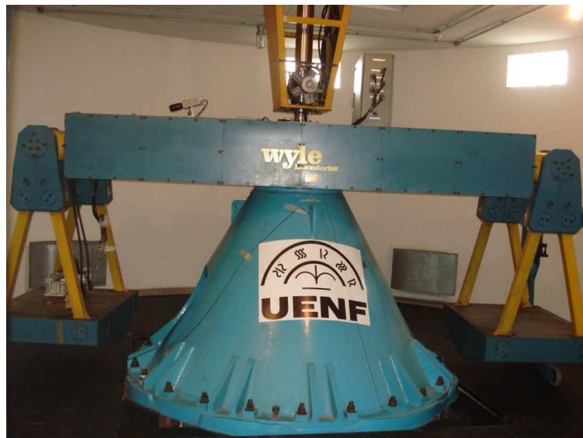
Figura 3.24. Vista da centrífuga com as plataformas
