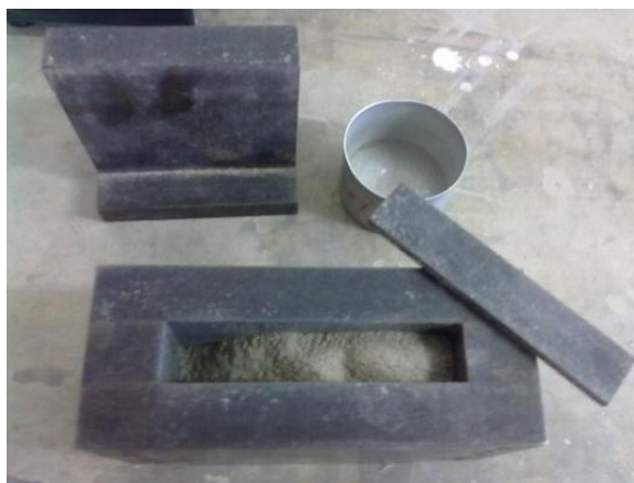
Figura 3.3 - Matriz retangular para confecção do corpo de prova
