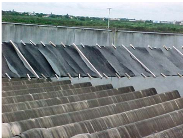
Figura 3.2. Amostras expostas com inclinação segundo a latitude local.
