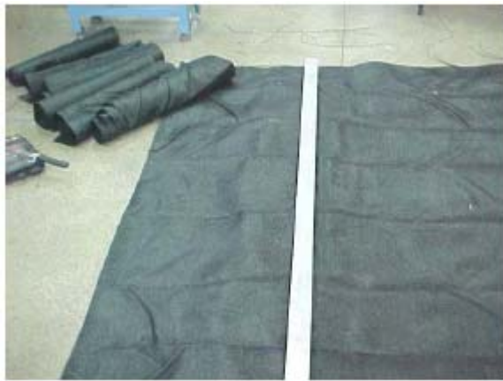
(a) Processo de Corte (Cunha Pinto, 2006) (b) Amostra com 20x50cm Figura 3.17. Procedimento de amostragem.
