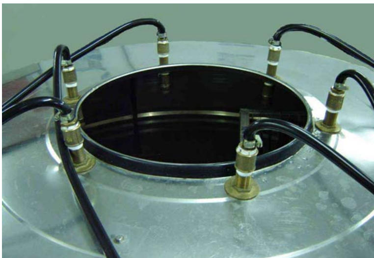
Figura 3.12. Detalhe da disposição dos aspersores dos sistemas de lixiviação no topo da câmara de degradação.
