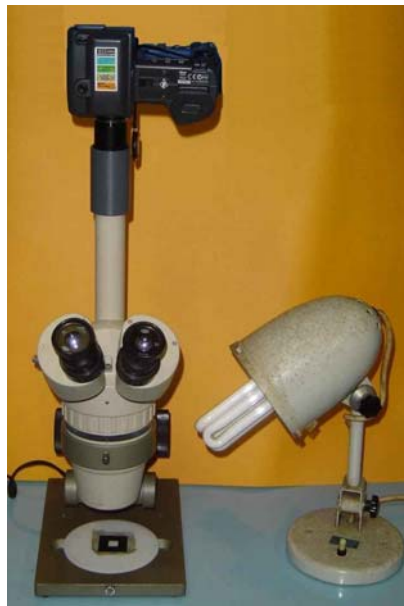
Figura 3.18. Estereoscópio, câmara fotográfica e fonte de iluminação utilizados na análise por microscopia ótica.
