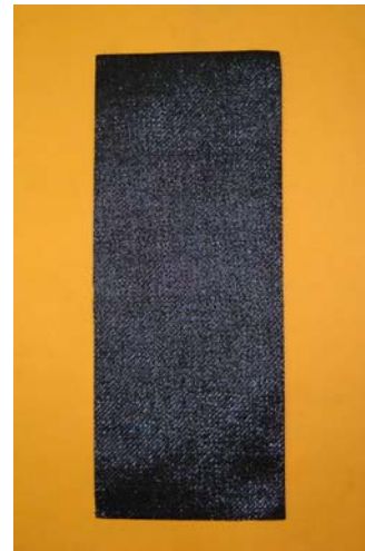
(a) Processo de Corte (Cunha Pinto, 2006) (b) Amostra com 20x50cm Figura 3.17. Procedimento de amostragem.
