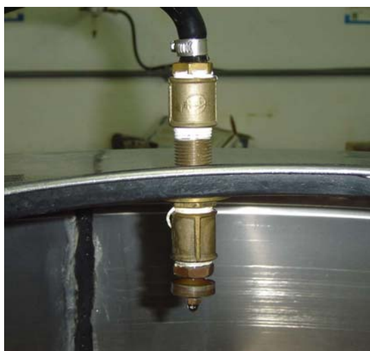
Figura 3.13. Detalhe do aspersor utilizado para lixiviação.
