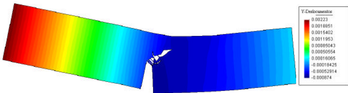
(b) – Configuração deformada e deslocamentos em y, caso B
