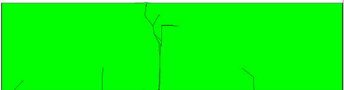
b) Propagação das fissuras, caso B
