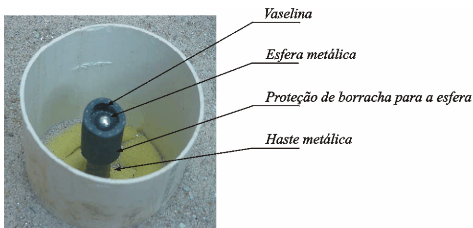
Figura 4. 7 – Detalhe da referência de nível utilizada no caso em estudo.
