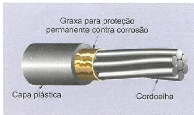
Figura 2.5 – Monocordoalha engraxada e plastificada com 7 fios, CAUDURO (1997).
