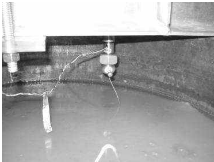
Figura 5.69 – Detalhe do adaptador da célula de carga e da folga na linha de ancoragem
