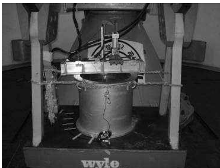
Figura 5.68 – Caixas de testes posicionada no cesto da centrífuga da UENF
