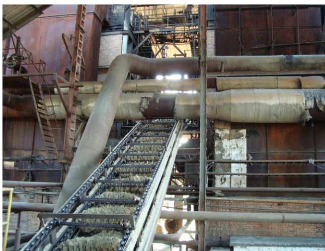
Figura 2.8 – Bagaço da cana-de-açúcar na esteira da usina Coagro em Campos dos Goytacazes/RJ.
