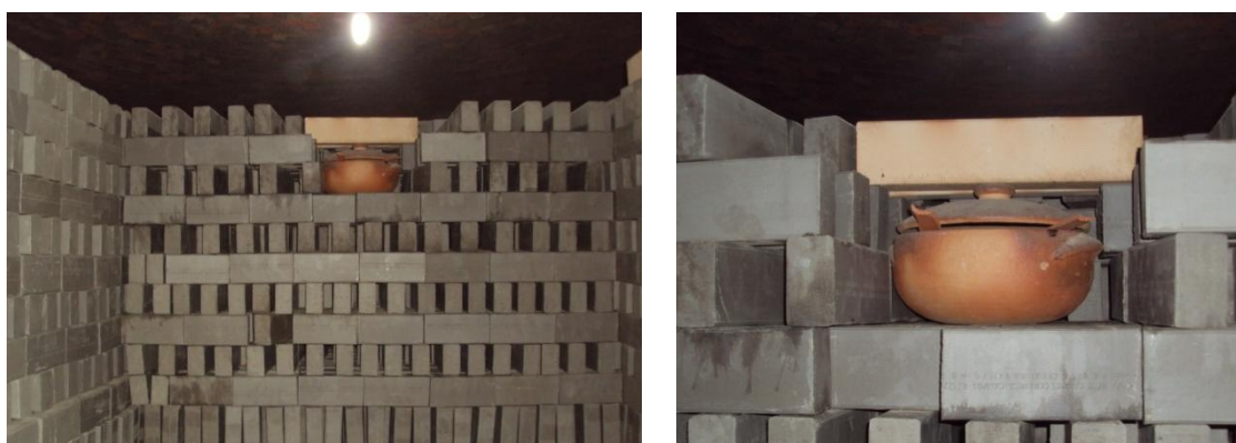
Figura 4.6 – (a) Recipiente com CBCA1 no forno e (b) detalhe do recipiente.
