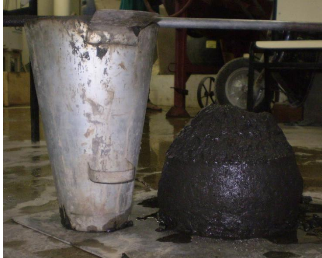
Figura 4.21 – Ensaio de abatimento do tronco de cone de Abrams do concreto com a cinza CBCA 2, realizado no LECIV/UENF.
