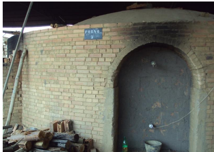
Figura 4.7 - Posicionamento de dois termopares em um das entradas do Forno 2 da Art Cerâmica.
