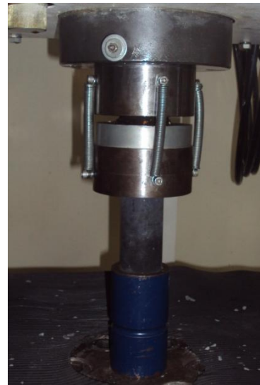
Figura 4.13 – (a) Faceamento e (b) ruptura de um corpo de prova no LABEST/COPPE.
