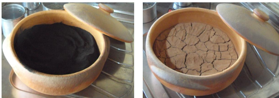
Figura 4.5 – Cinza CBCA 2 no recipiente cerâmico (a) antes da queima e (b) após a queima.
