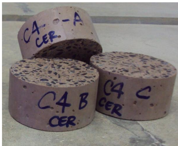
Figura 4.22 – Corpo de prova com 20 cm de altura e 10 cm de diâmetro cortado em 3 partes com 5 cm de altura.
