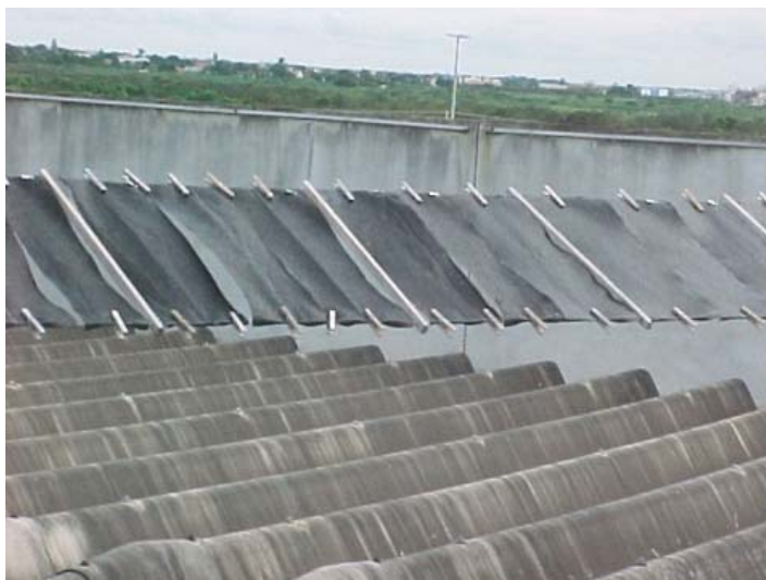
Figura 4.3 - Amostras expostas com inclinação segundo a latitude local.
