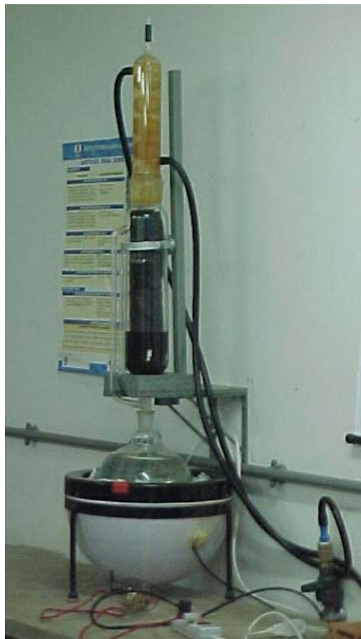
Figura 4.10 - Equipamento Soxhlet convencional para ensaios de lixiviação contínua, cedido pela PUC-Rio.
