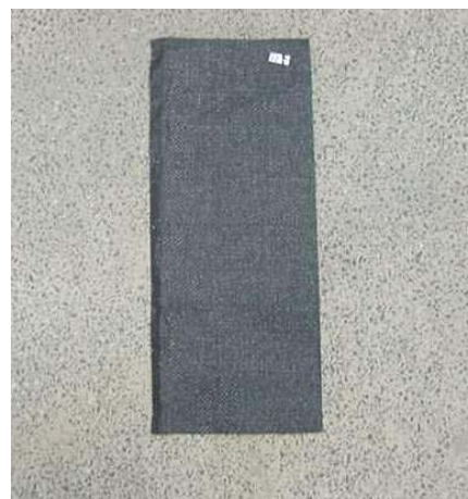
(b) amostra com 20 x 50cm, pronta para ensaio
