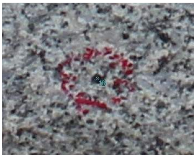
Figura 43: Marcação manual dos grãos dos minerais na superfície do maciço na primeira campanha de ensaios usando a função "Mark Points".
