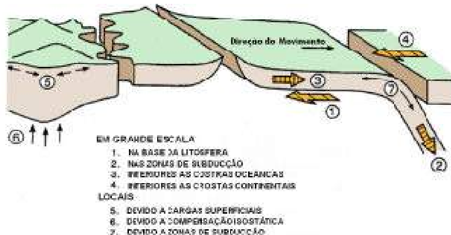
Figura 3: Origem e orientação das tensões tectônicas. (Zoback et al, 1989), extraído de (Paredes, 2007a)
