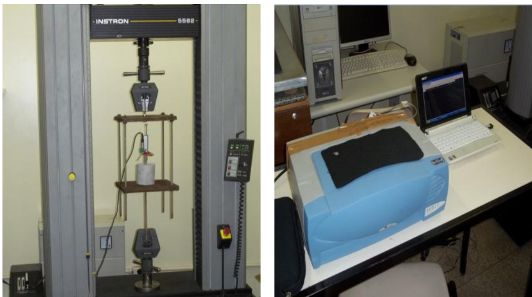
Figura 3.31 – Esquema para o ensaio de arrancamento: (a) corpo de prova na prensa e placa metálica; (b) sistema de aquisição de dados.
