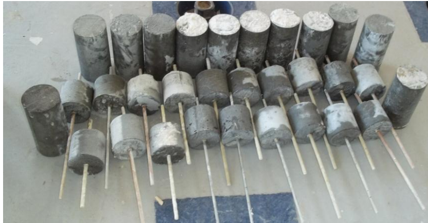
Figura 3.27- Corpos de prova ensaiados (a) 58 MPa e de (b) 47 MPa
