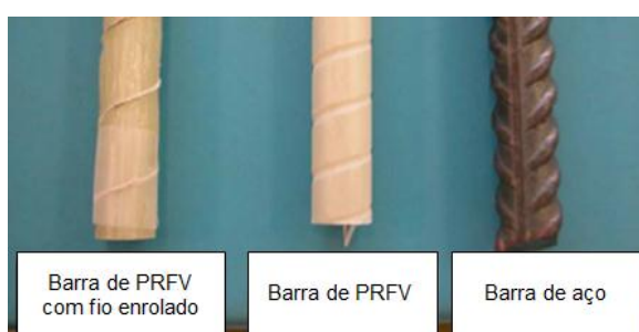
Figura 2.40 - Barras ensaiadas na pesquisa (HARAJILI et al. , 2011).
