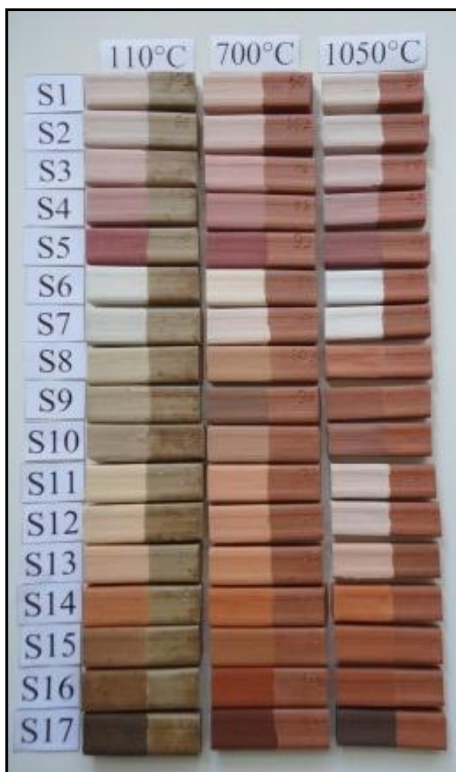
Figura 5.4: Corpos de prova pintados com engobes passados na peneira #200, antes e após a queima.
