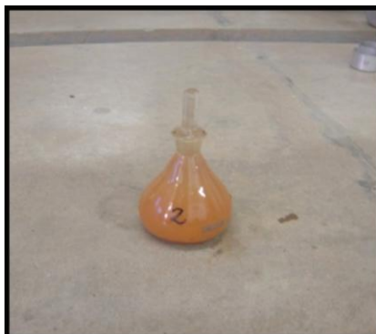
Figura 4.6: Ensaio de Massa Específica Real dos Grãos pelo método do picnômetro.
