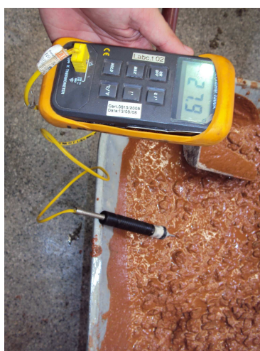
Figura 26 Medição da temperatura do concreto.
