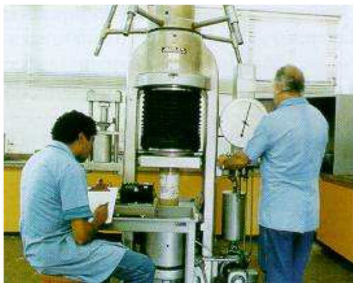
Figura 29 Realização de ensaio de módulo de elasticidade utilizando extensômetro elétrico Carlson.(Laboratório de Concreto de Furnas)
