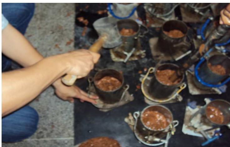
Figura 25 Adensamento do concreto.
