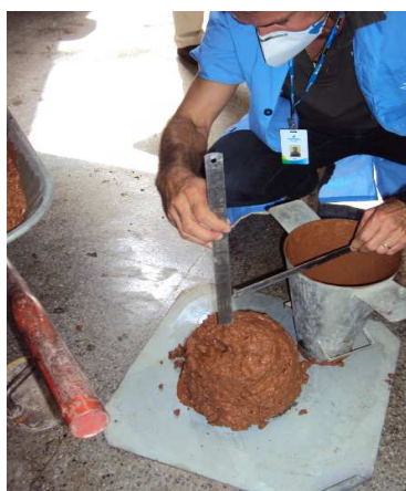
Figura 24 Abatimento do tronco de cone.
