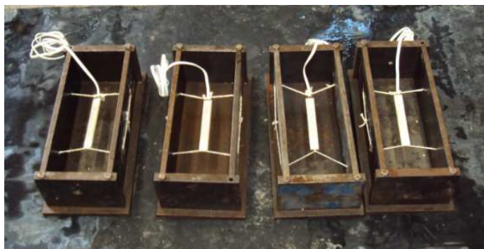
Figura 27 Formas instrumentadas das para ensaios de retração.
