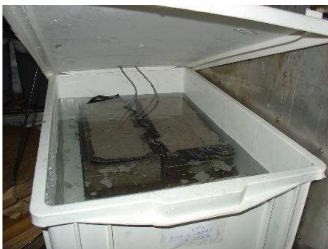
Figura 31 Estocagem dos corpos-de-prova dentro de caixa plástica com água. (Laboratório de Concreto de Furnas)
