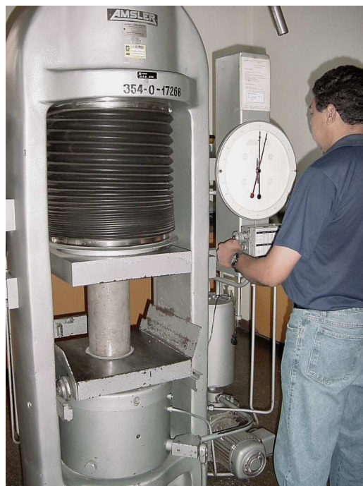
Figura 28 Ensaio de resistência à compressão - NBR 5739/2007. (Laboratório de Concreto de Furnas)
